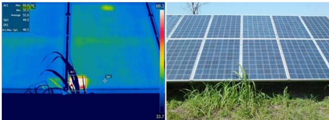
Slika 4.22. Temperature razlike do kojih je došlo zbog zasjenjivanje modula [15]
