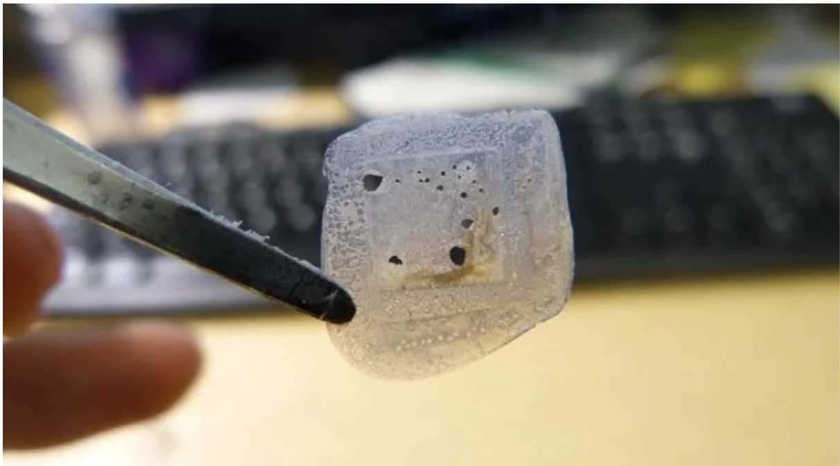
S1.4.3.2. Čip nakon uništenja kemijskom reakcijom [15]
