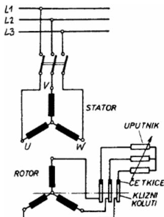
Slika 1.3. Tropolna shema kolutnog asinkronog motora [4]
