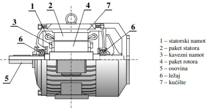
Slika 1.1. – Građa asinkronog motora [2]
