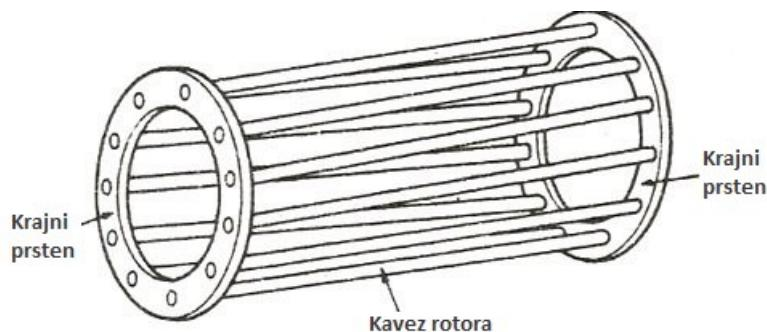
Slika 1.5. Shematski prikaz kavezognog rotora [6]
