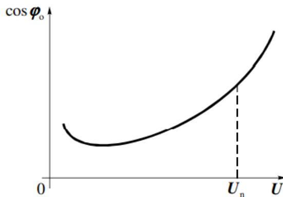
Slika 4.5: Karakteristični faktor snage asinkronog motora [2]
