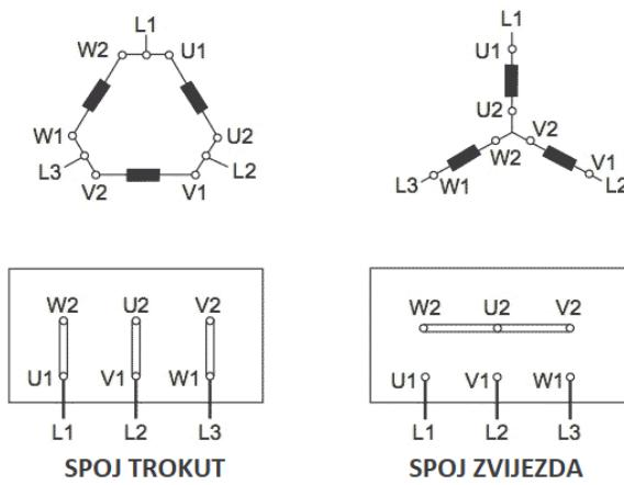
Slika 1.2. Vrste spoja statorskog trofaznog namota [3]
