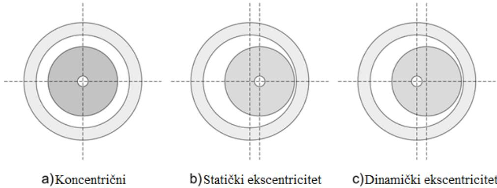
Slika 3.5: Vrste ekscentriciteta rotora [13]
