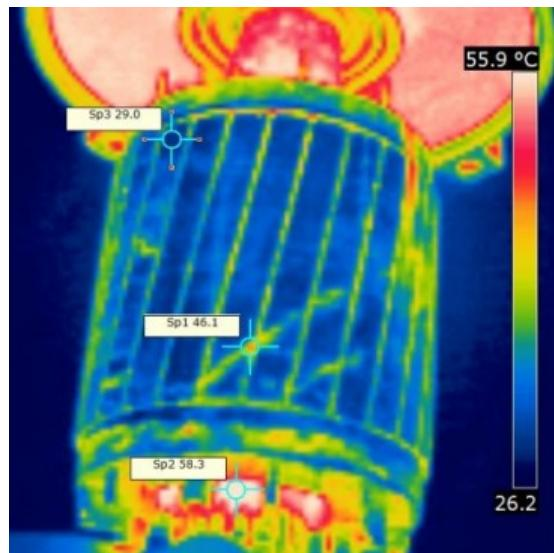
Slika 4.1: Slika rotorskog paketa i kaveza uslikana termokamerom 1 minuti nakon isključenja motora [19]
