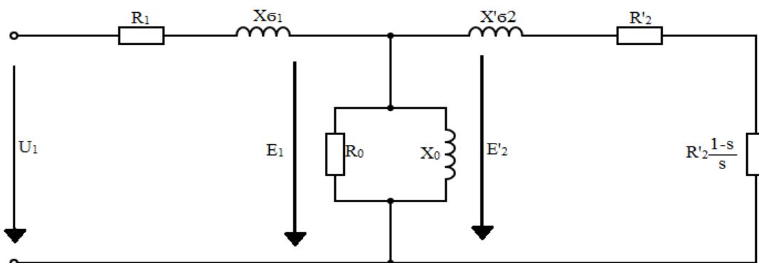
Slika 1.6. Nadomjesna shema kavezognog asinkronog motora
