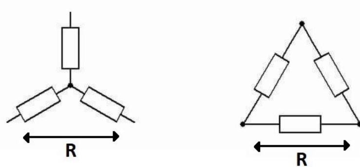
Slika 4.8: Otpori između stezaljki namota: a) spoj zvijezda, b) spoj trokut
