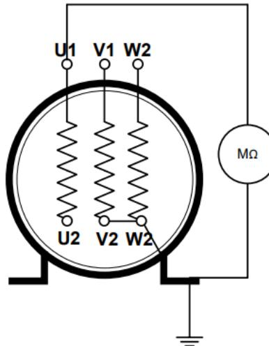
Slika 4.9: Mjerjenje izolacijskog otpora namota [19]
