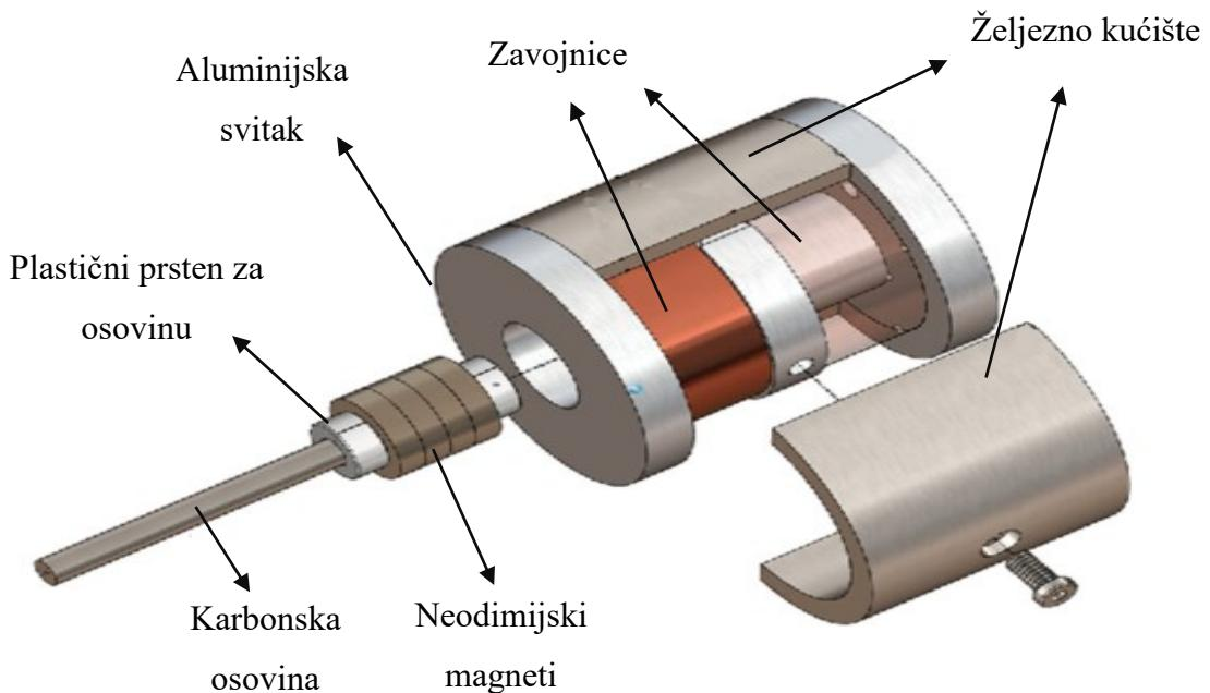
Slika 5.12. Dijelovi linearног aktuatora s pokretnim magnetom [17]
