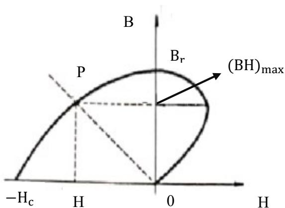
Slika 3.15. Određivanje radne točke trajnih magnet [9]
