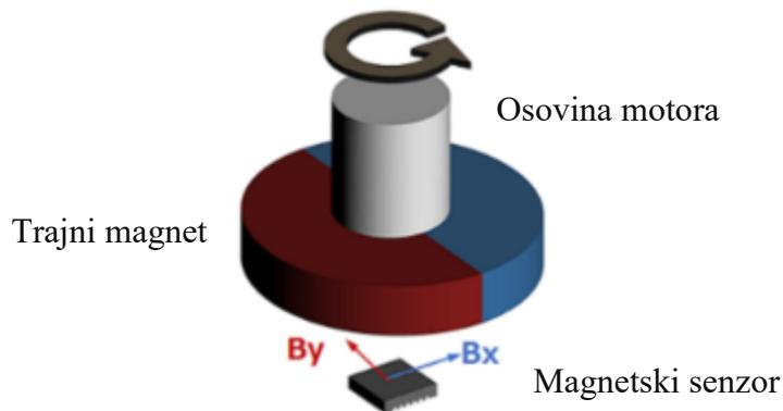
**Slika 5.18.** Magnetski enkoder sa dva Hallova elementa [22]
