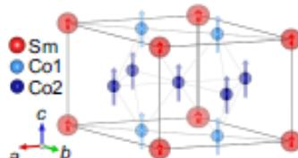
**Slika 4.3. Kristalne strukture  $SmCo_5$ , strelice označavaju smjerove magnetskog momenta iona [10]**
