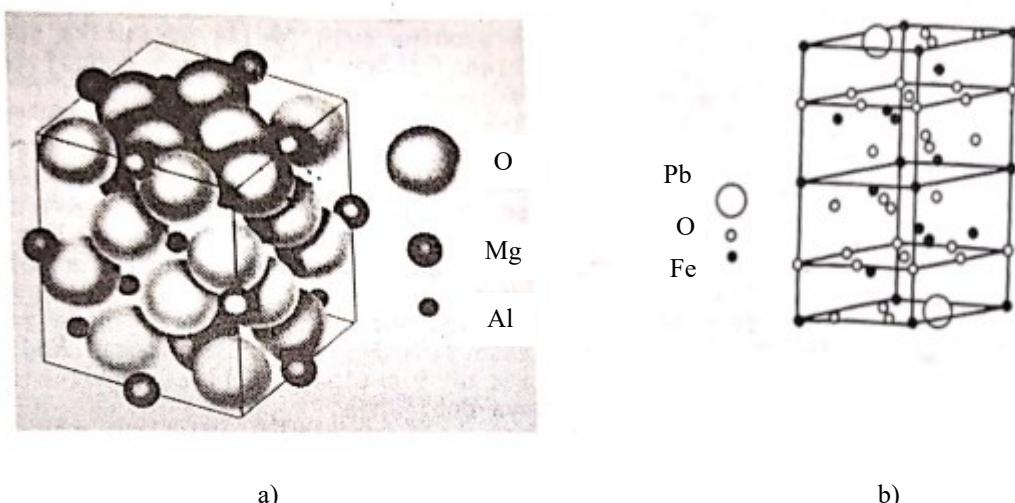
Slika 3.16. a) Kristalna struktura spinela, b)
