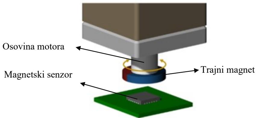
Slika 5.15. Magnetski enkoder [22]
