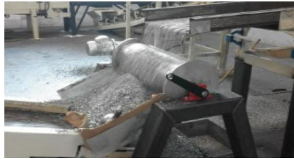
**Slika 5.4.** Valjkasti magnetski separator u postrojenju [13]
