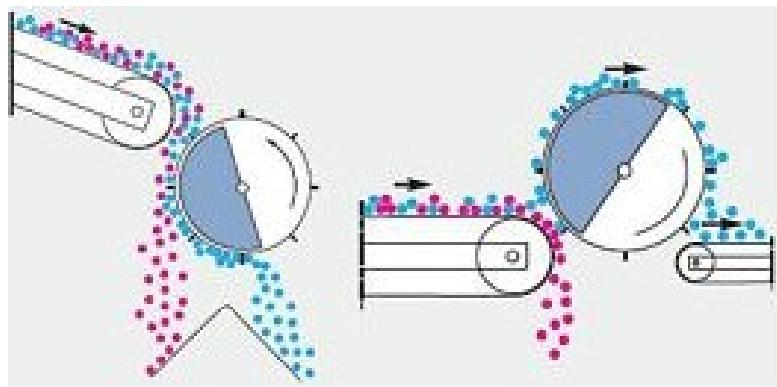
**Slika 5.3.** Prikaz rada valjkastog magnetskog separatora [11]
