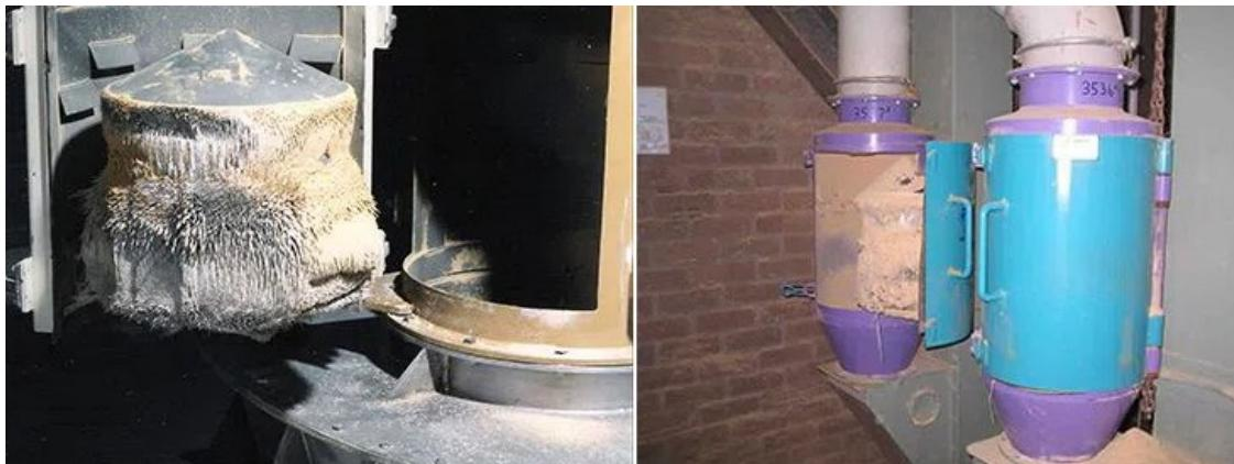
**Slika 5.2.** Magnetski bullet separatori u postrojenjima [11]
