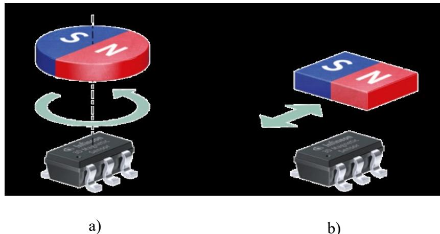
Slika 5.13. Magnetski senzori: a) kutnog položaja, b) linearног položaja [20]
