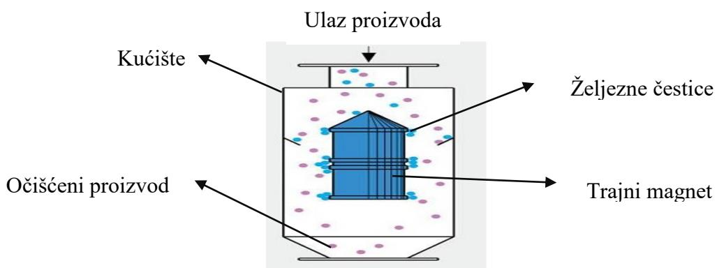
Slika 5.1. Princip rada magnetskog bullet separatora [11]
