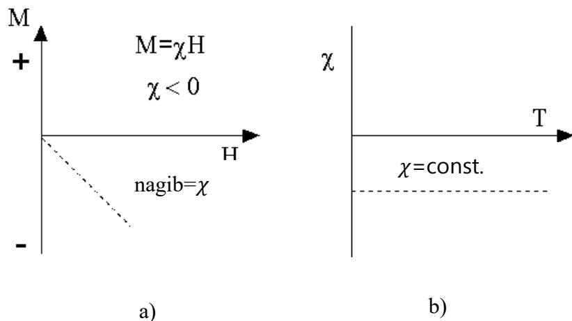
**Slika 3.2.** Grafički prikaz ovisnosti magnetizacije o jakosti magnetskog polja (a), te ovisnosti susceptibilnosti o temperaturi (b) [4]
