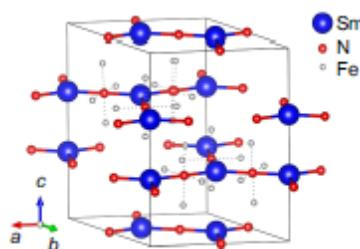
**Slika 4.4.** Kristalna struktura  $\text{Sm}_2\text{Fe}_{17}\text{N}_3$ , strelice označavaju smjerove magnetskog momenta iona [10]
