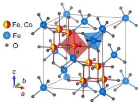
Slika 4.7. Kristalna struktura ferita  $\text{CoFe}_2\text{O}_4$  [10]
