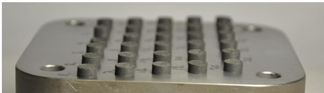
Slika 5.22. Primjer 3D ispisanih trajnih magneta [26]
