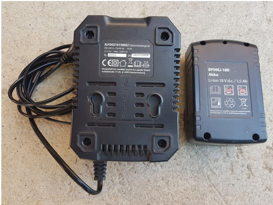
Sl. 5.6. Baterija i kućište baterije električnog trimera
