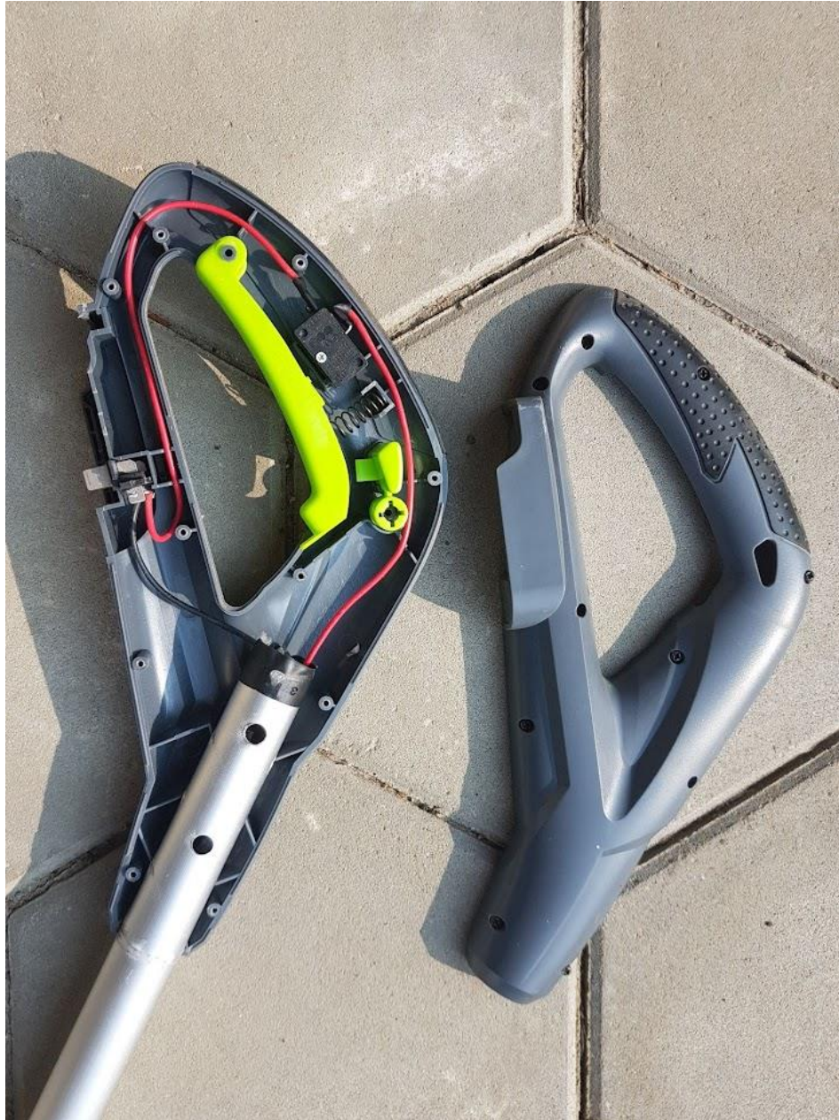
Sl. 5.4. Prikaz rastavljene ručke električnog trimera
