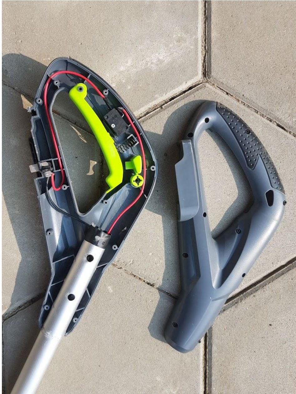
Sl. 5.4. Prikaz rastavljene ručke električnog trimera
