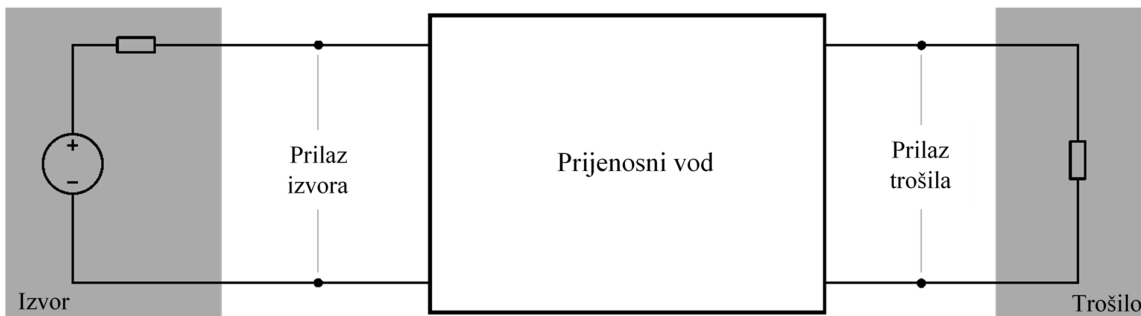
Slika 5.2: Prijenosni vod kao dvoprilazna mreža koja povezuje izvor i trošilo
