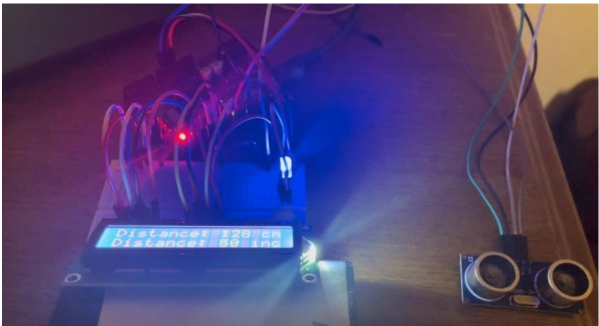
Slika 3.9. Realizacija sklopa za mjerenje udaljenosti zasnovanog na ultrazvučnom senzoru
