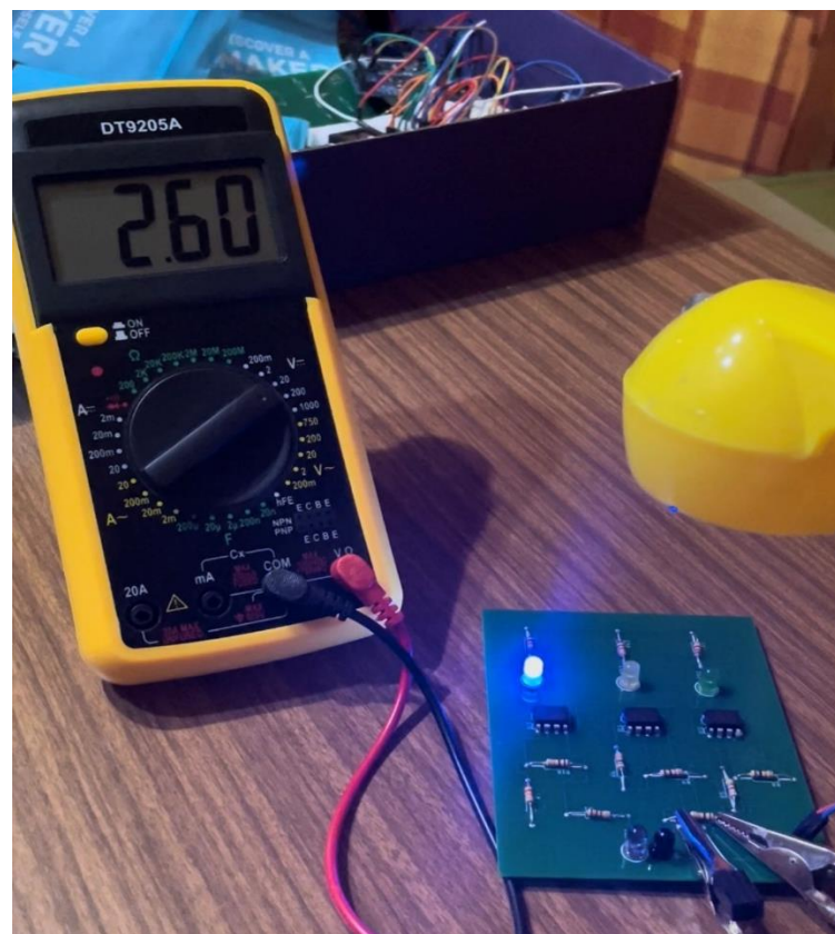
Slika 4.13. Detekcija plastičnog objekta žute boje na udaljenosti od 16 cm
