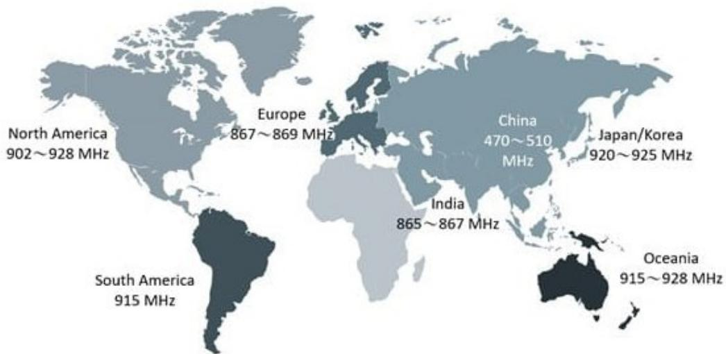
Slika 3.1. Frekvencijski pojasevi za LoRa tehnologiju [7]
