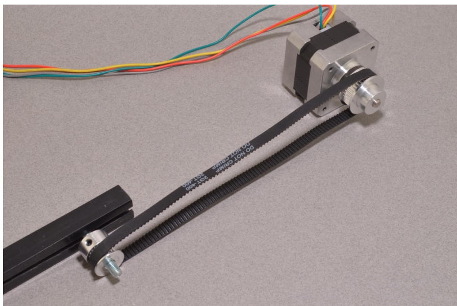
Slika 3.3. Pojednostavljena petlja pisača s GT2 remenom [9]
