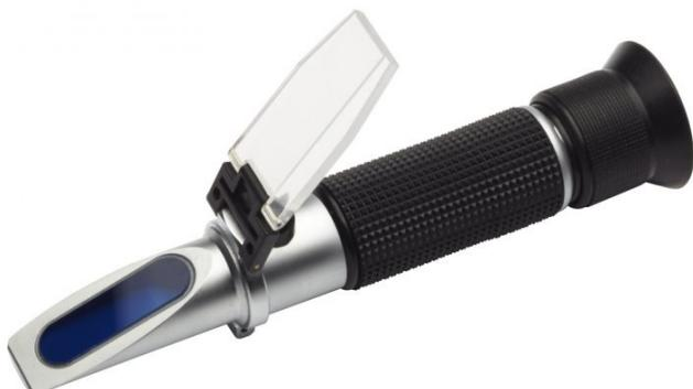
Slika 2.3. Analogni refraktometar
