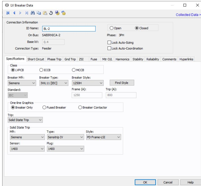
**Slika 4.7.** Podaci Siemens prekidača (ispod SABIRNICA-2) iz programskog alata EasyPower [8]
