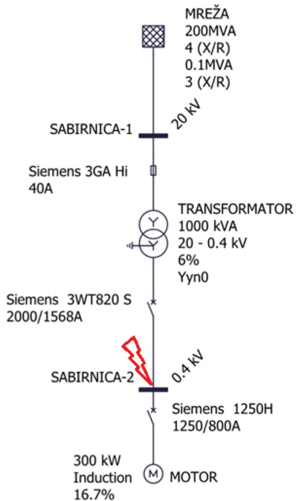
**Slika 4.1.** Shema jednostavnog spoja mreža-trafo-motor iz programskog alata EasyPower [8]
