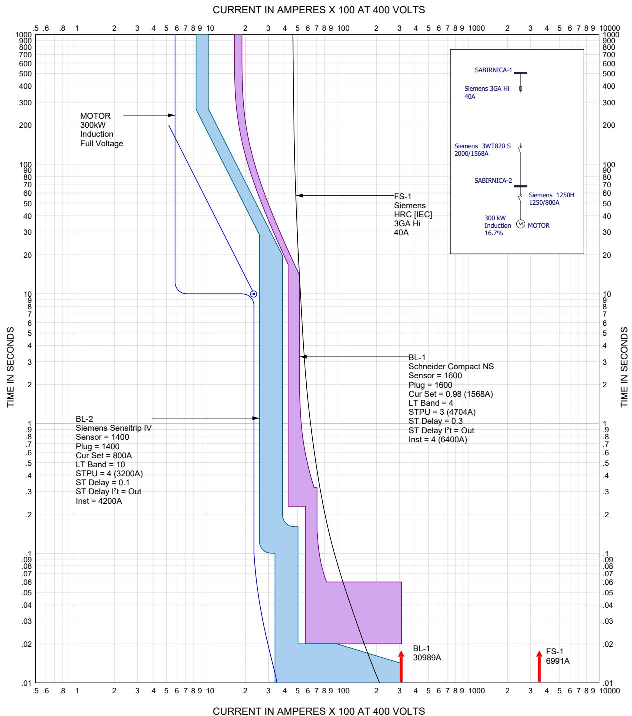
**Slika 4.8.** Krivulja prorade zaštite pri kratkom spoju u programskom alatu EasyPower [8]
