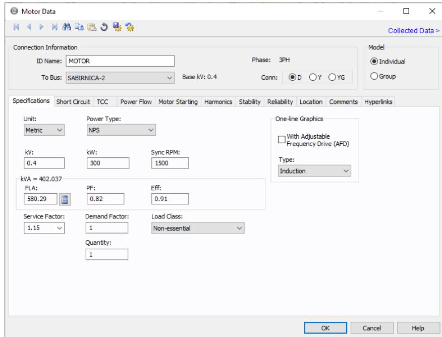
**Slika 4.2.** Podaci motora iz programskog alata EasyPower [8]
