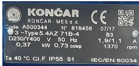
Slika 2.3. Natpisna pločica asinkronog motora
