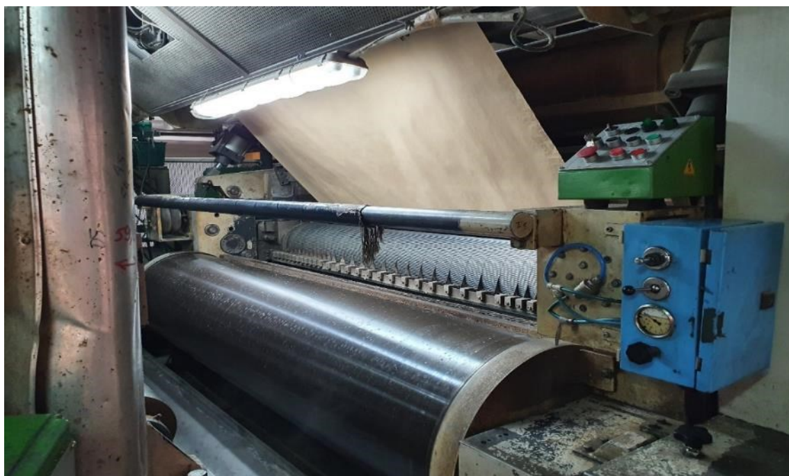
Slika 4.6. Rebrasti valjak za formiranje valova (fotografirano 1.8.2022)
