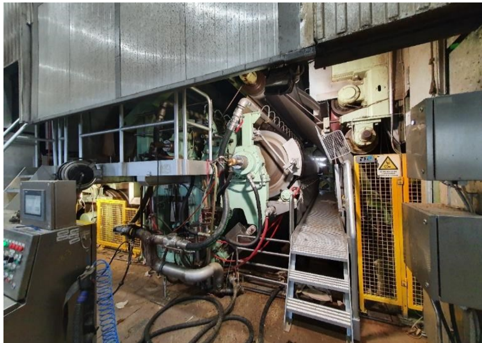
Slika 3.7. Lime preša (dodavanje škroba)(fotografirano 20. lipnja 2022)
