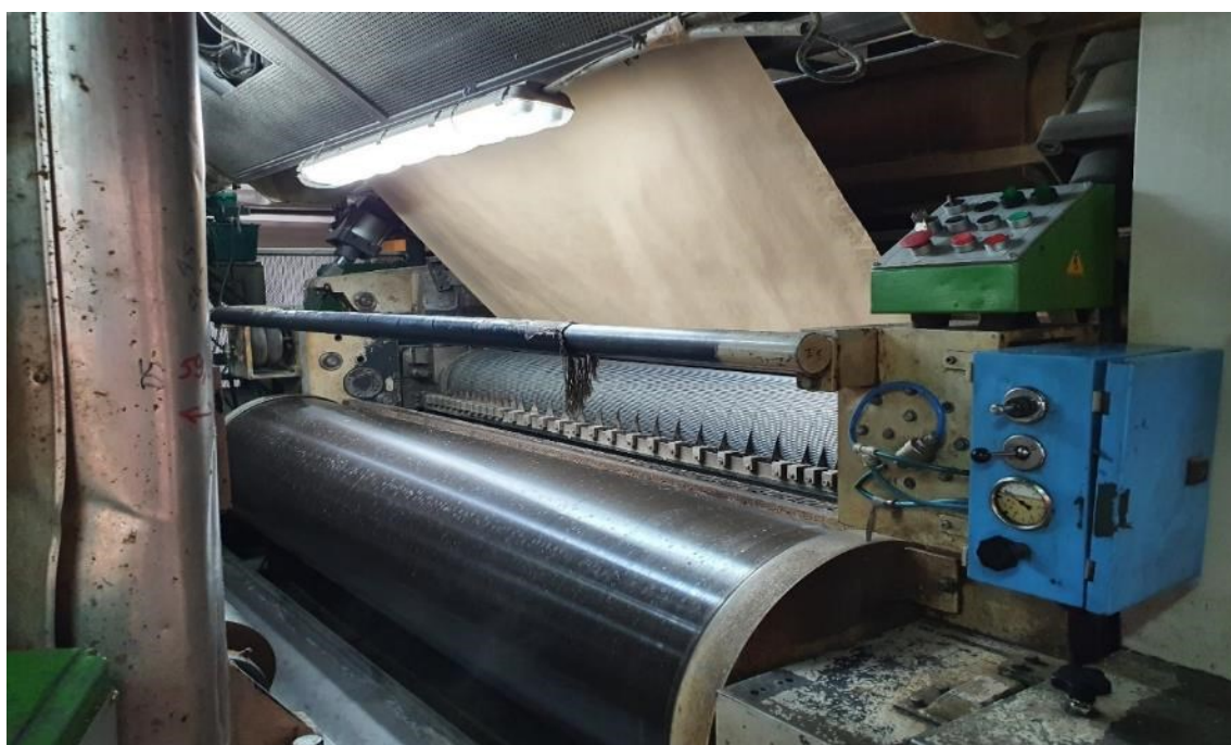
Slika 4.6. Rebrasti valjak za formiranje valova (fotografirano 1.8.2022)
