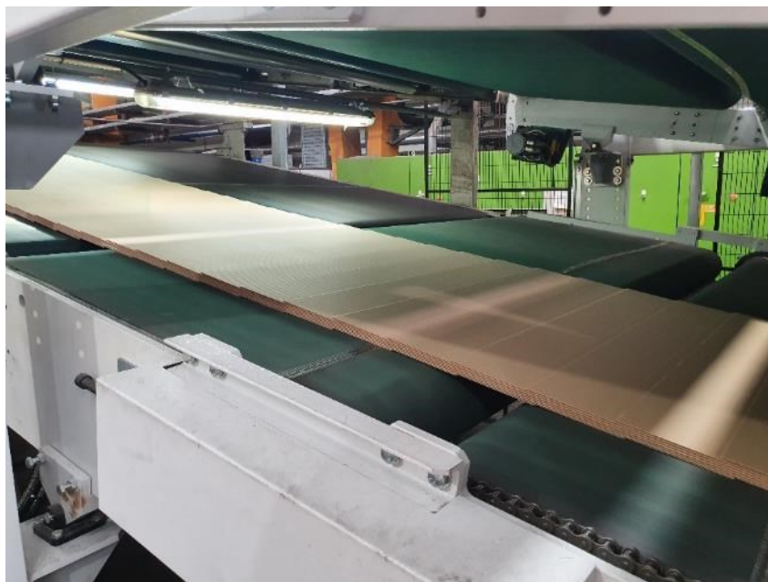
Slika 4.12. Transport izrezanih kartonskih ploča na platformu za slaganje (fotografirano 9. kolovoza 2022.)
