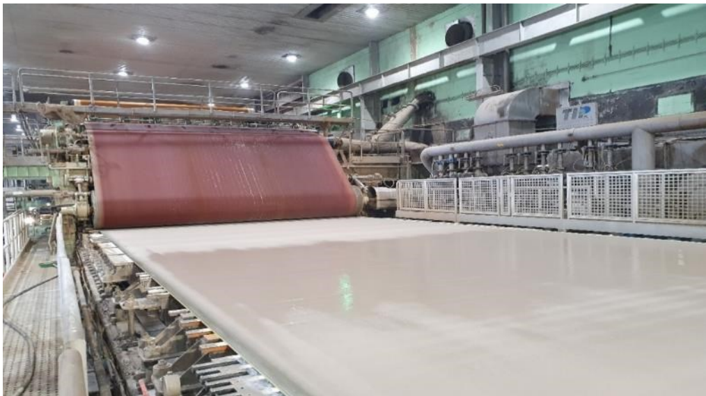
Slika 3.5. Prijelaz sa formirnog na flitz sito (fotografirano 20. lipnja 2022)
