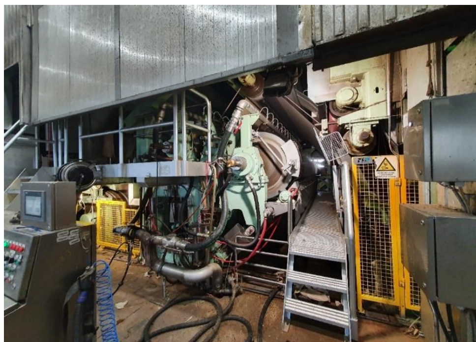
Slika 3.7. Lime preša (dodavanje škroba)(fotografirano 20. lipnja 2022)
