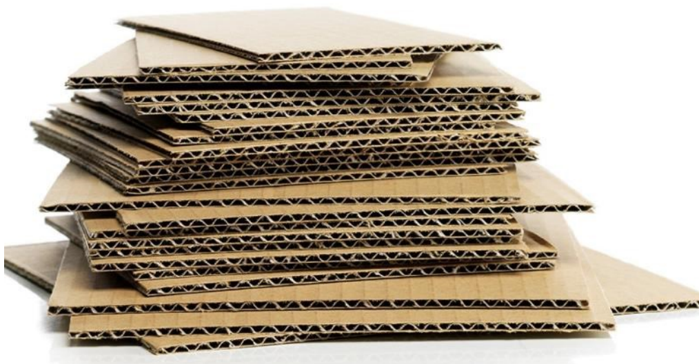
Slika 4.2. Troslojni karton (slika preuzeta iz literature [8])
