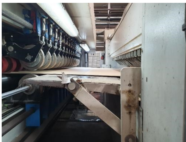
Slika 4.10. Rilovi za žlijebljenje kartona (fotografirano 9. kolovoza 2022.)
