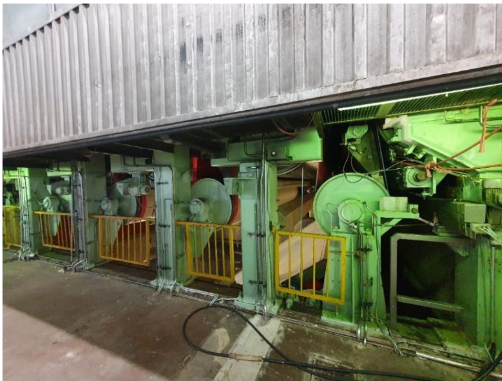
Slika 3.6. Komora s cilindrima za sušenje suhom parom (fotografirano 20. lipnja 2022)
