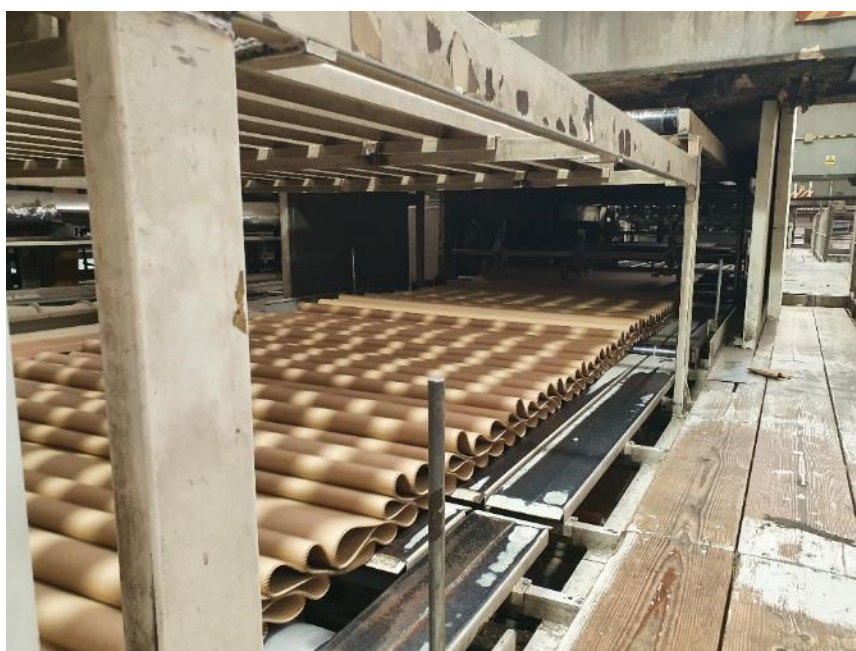
Slika 4.8. Transportna traka dvoslojnog papira (fotografirano 9. kolovoza 2022.)
