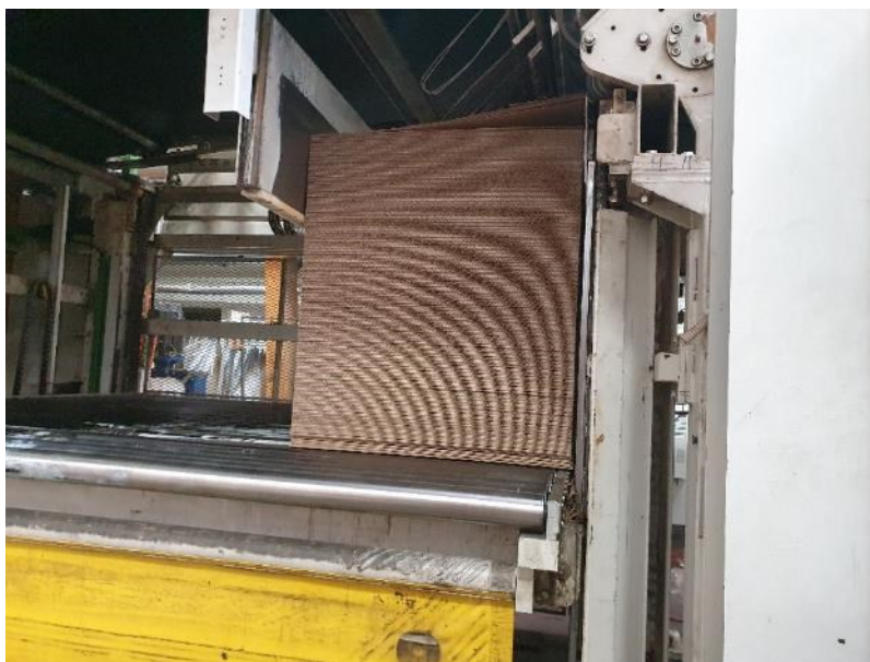
Slika 4.13. Slaganje kartonskih ploča u blokove na platformi za dizanje i spuštanje (fotografirano 9. kolovoza 2022.)
