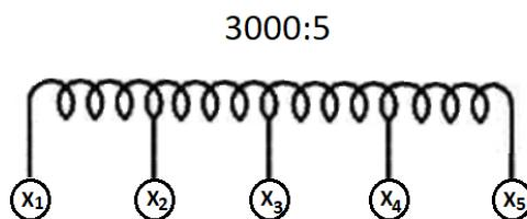
Sl. 4.6. Stezaljke strujnog mjernog transformatora za različite omjere.
