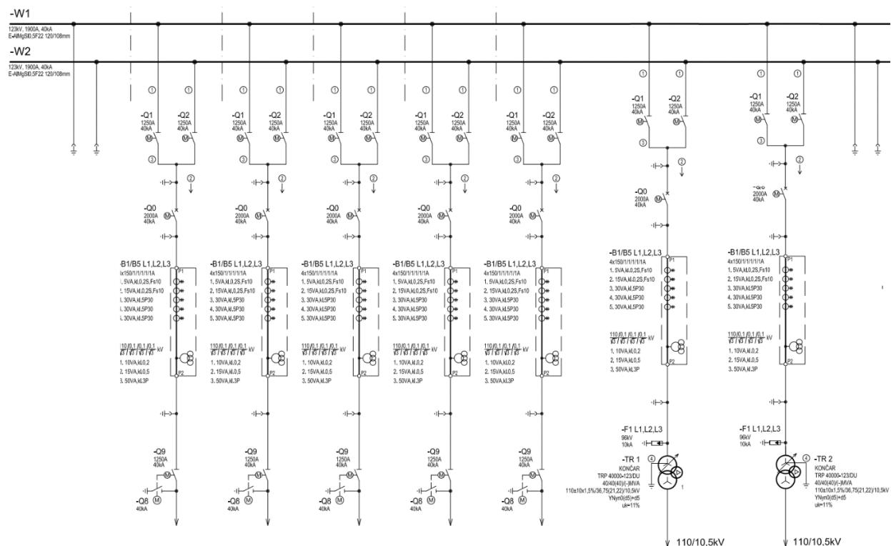
Sl. 6.1. Jednopolna shema vodnog polja napona 110kV
