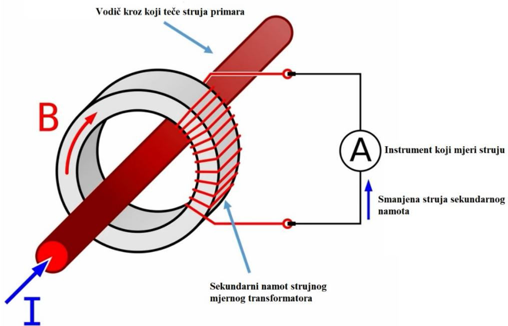
Sl. 4.1. Smanjivanje i mjerjenje struje kroz vodič. [14]
