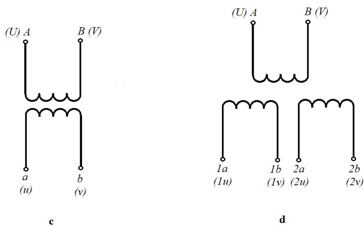
Sl. 3.12. **c** – jednopolno izolirani naponski mjerni transformator s jednim sekundarnim namotom, **d** - jednopolno izolirani naponski mjerni transformator s dva sekundarna namota
