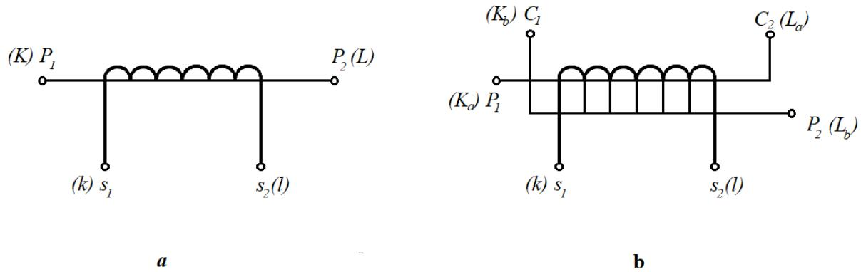
Sl. 4.8. a – strujni mjerni transformator s jednom jezgrom, b – strujni mjerni transformator s jednom jezgrom prespojiv na primarnoj strani (serijski i paralelno)
