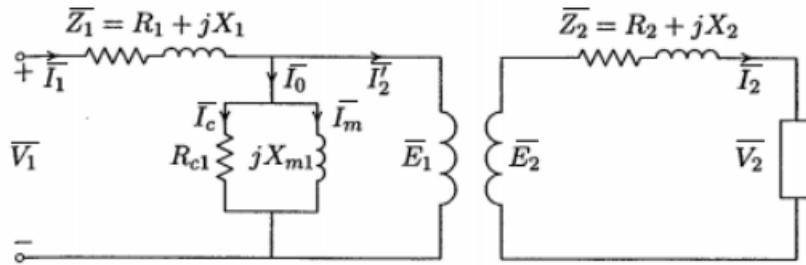
Sl. 3.2. Shema idealnog transformatora s realnim gubitcima. [1]
