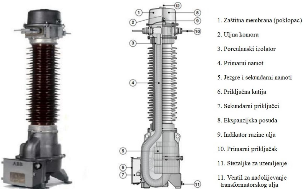
Sl. 4.16. Visokonaponski uljni strujni mjeri transformator s označenim dijelovima. [23]
