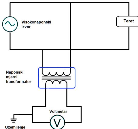
Sl. 3.4. Jednopolna shema paralelnog spojenog naponskog mjernog transformatora
