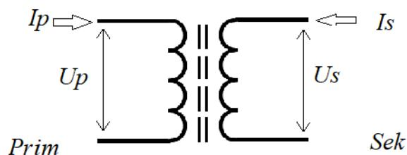
Sl. 3.1. Jednopolna shema idealnog transformatora.
