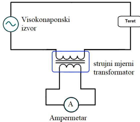
Sl. 4.3. Jednopolna shema serijsko spojenog strujnog transformatora
