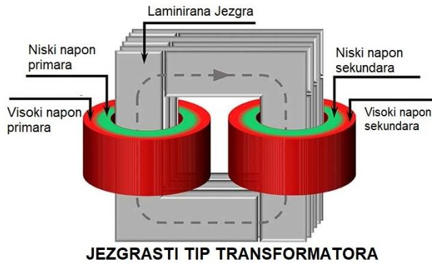
Sl. 3.6. Jezgrasti tip naponskog mjernog transformatora. [10]
