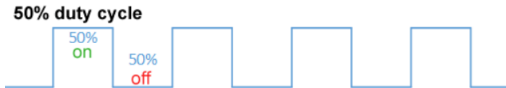
Sl. 3.4. PWM sa duty cycle od 50%.
