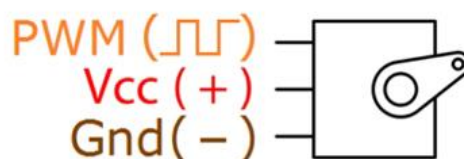
Sl. 3.3. Način spajanja servo motora.
