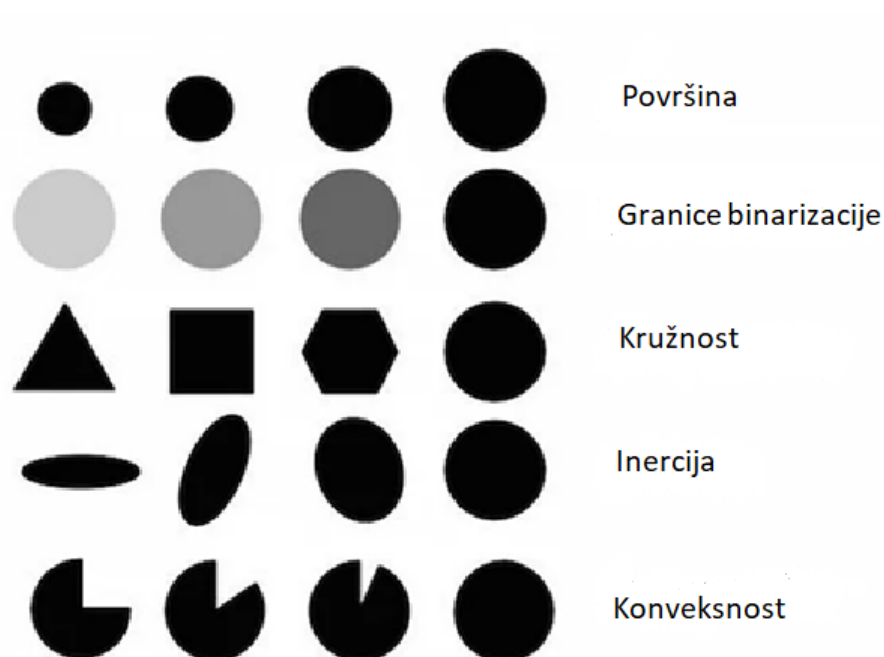
Slika 3.6. Parametri Blob algoritma, [6].
