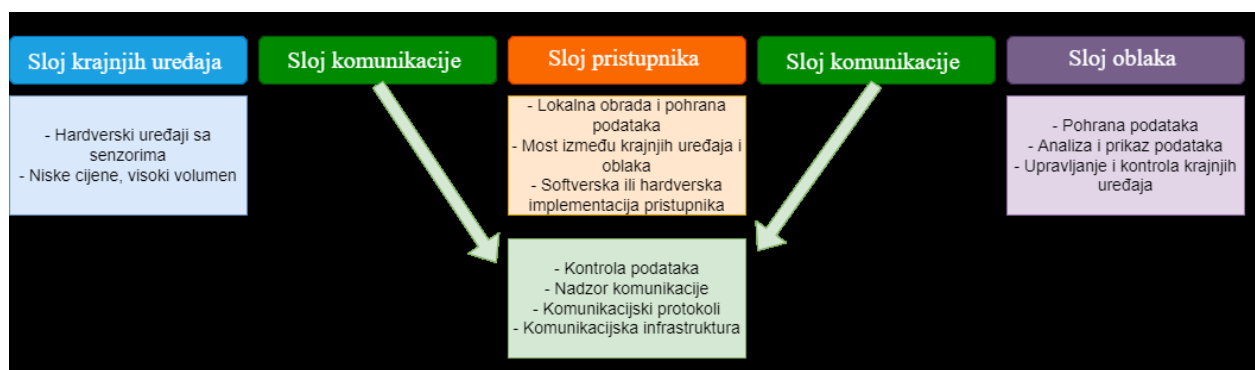
Slika 2.1. Podjela IoT-a po slojevima.
