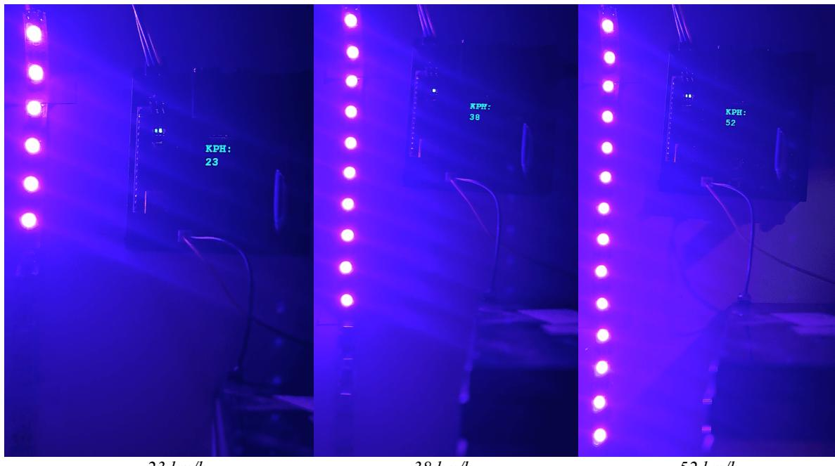
Sl. 3.41. Paljenje ledica povećanjem brzine.
