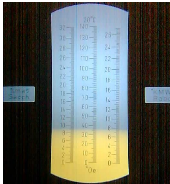
Slika 4.7. Skala refraktometra slikana uređajem
