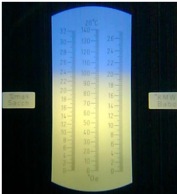
Slika 4.3. Skala refraktometra slikana uređajem
