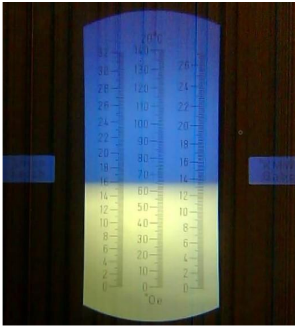
Slika 4.5. Skala refraktometra slikana uređajem
