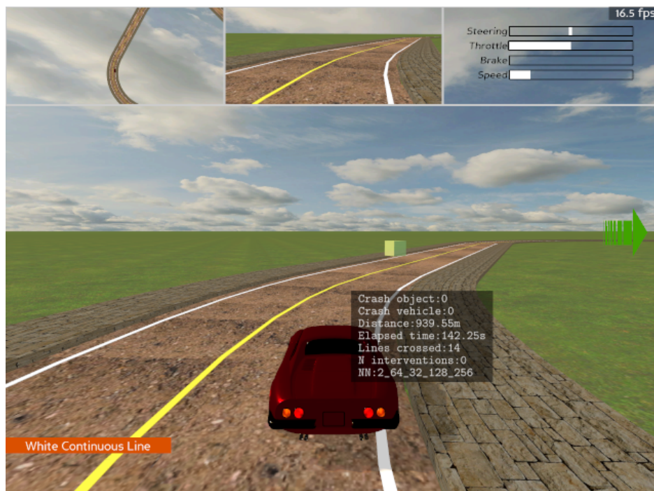
Slika 3.26: Grafičko sučelje u MetaDrive simulatoru s ispisom broja prelazaka kolničkih crta, broja intervencija, prijeđene udaljenosti i proteklog vremena
