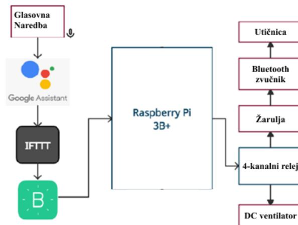
Slika 2.3. Proces od glasovne poruke do izvršnih uređaja za uređaj opisan u [4].
