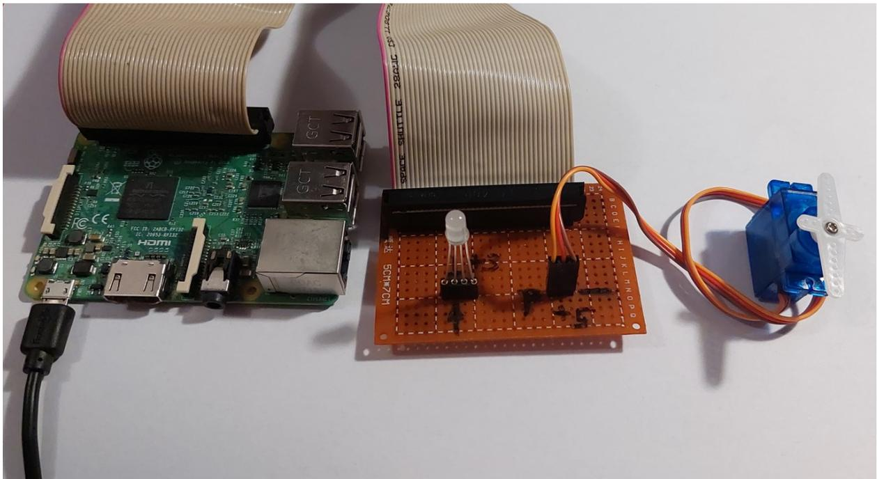
**Slika 5.5.** Izvršni uređaji spojeni na Raspberry Pi.
