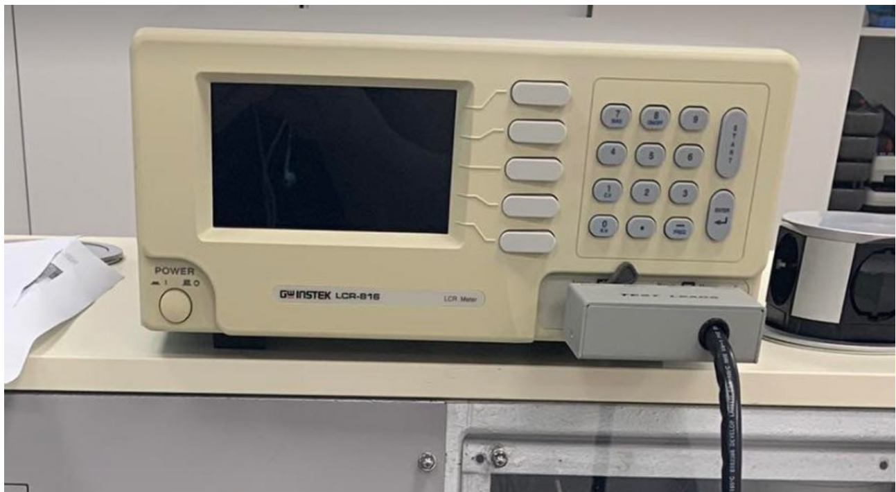
Slika 14.10. RCL metar "Gwinstek LCR-816"
