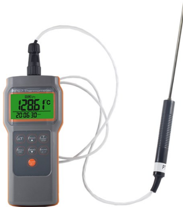
Slika 4.2 Pt100 RTD termometar [16]
