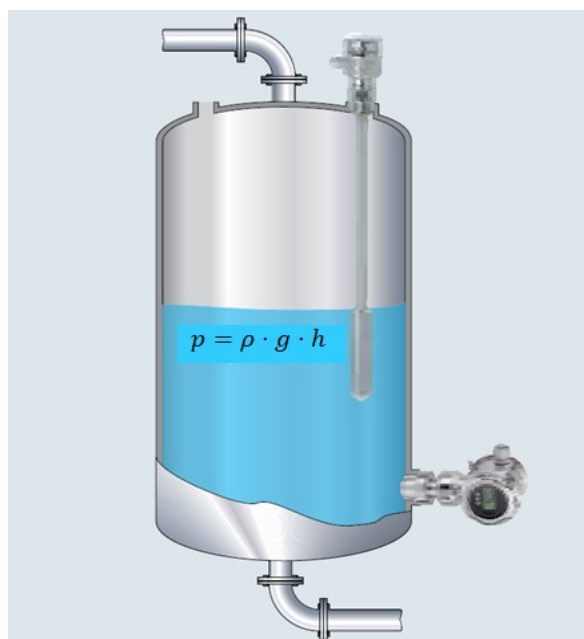
Slika 3.2. Hidrostatsko mjerenje razine u otvorenom spremniku [7]
