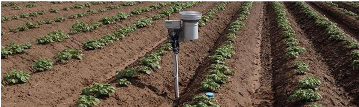
**Slika 6.2.** Senzor temperature i vlage
