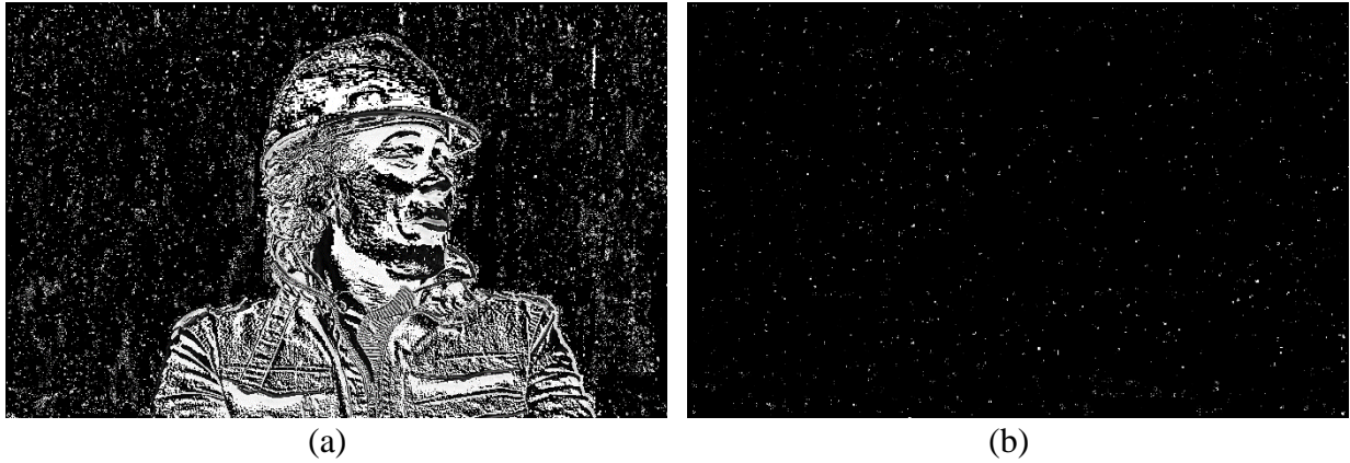
Slika 3.3. Apsolutna razlika luminantne komponente dvaju uzastopnih okvira: (a) bez smrzavanja, (b) pri smrzavanju
