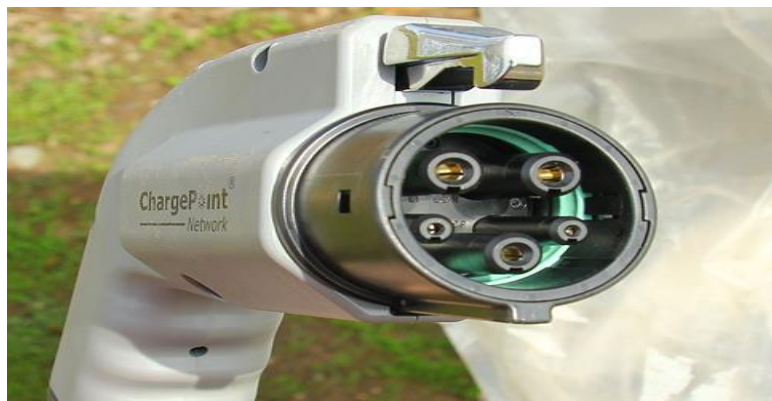
Slika 5.1 Prikaz priključka Tip 1 SAE J1772-2009[29]
