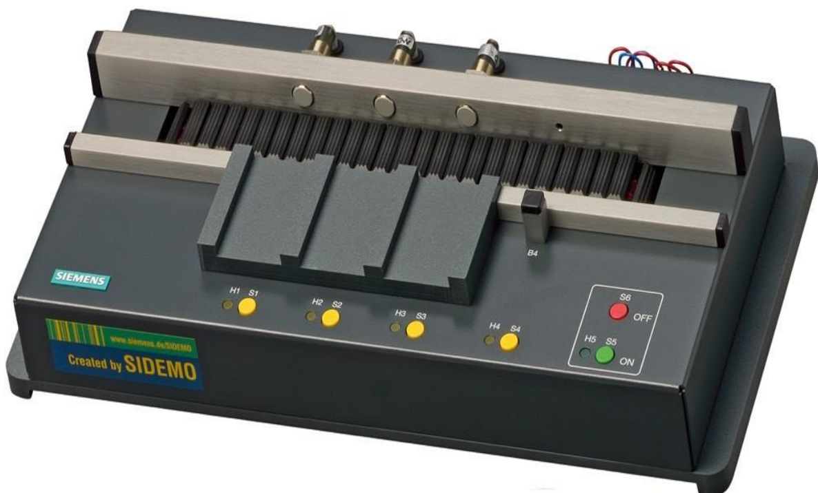
Slika 3.1. Maketa pokretne trake [1]
