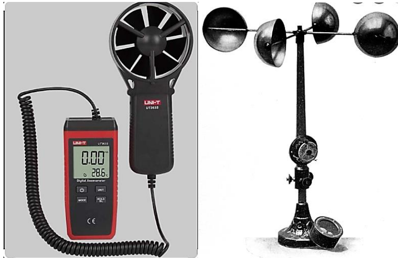
Slika 3.2 Anemometar za ručnu primjenu i onaj koji se instalira na krov ili neku povišenu podlogu
