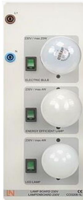
Slika 4.14 Panel žarulja 230 V [3] i [4]
