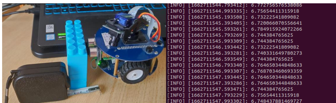
Slika 5.3 Greška prilikom računanja udaljenosti ultrazvučnog senzora
