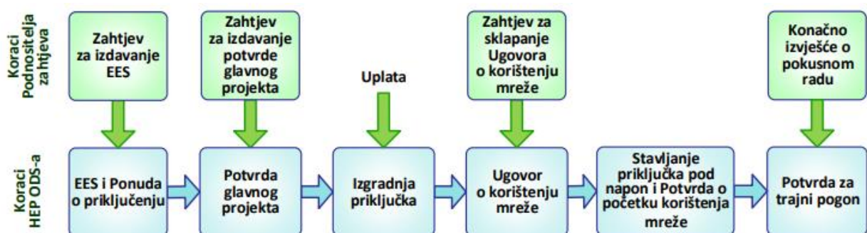
Slika 4.1. Osnovni koraci pri jednostavnom priključenju na distribucijsku mrežu [24]
