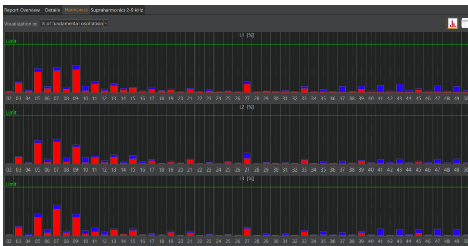
Slika 4.9. Prikaz vrijednosti harmonika napona po fazama
