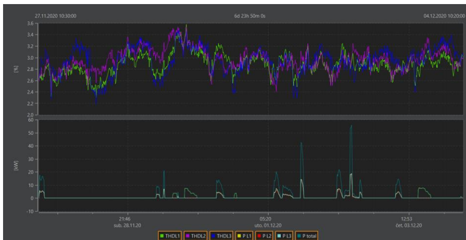
Slika 4.10. Grafički prikaz THD napona [%] i snage [kW]
