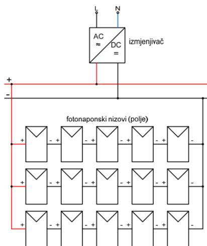
Slika 4. 7. FN sustav s centralnim izmjenjivačem[26]
