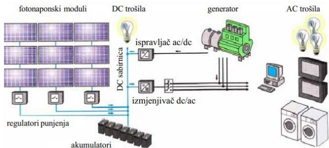
Slika 4. 4. Primjer hibridnog FN sustava s generatorom[25]
