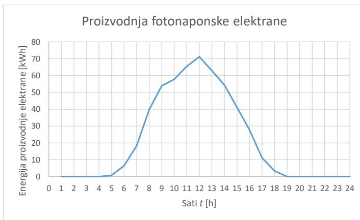
Slika 6. 1. Proizvodnje fotonaponske elektrane zgrade za ljetni dan (20.07.2020)
