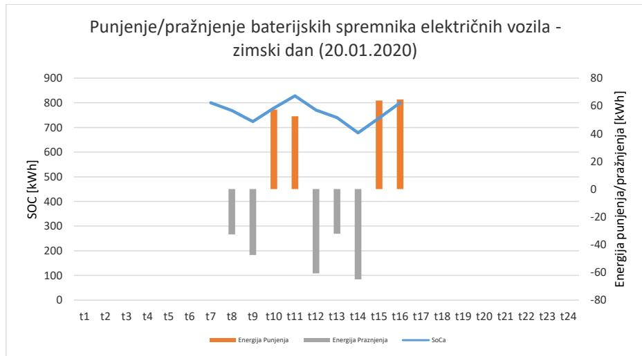
Slika 6. 11. Optimalno punjenje/praznjenje baterijskih spremnika električnih vozila na zimski dan
