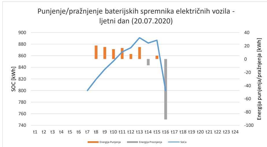
Slika 6. 10. Optimalno punjenje/praznjenje baterijskih spremnika električnih vozila na ljetni dan
