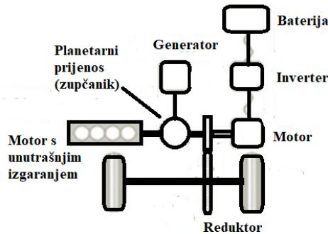
Slika 3. 6. Shema serijsko - paralelnog hibridnog pogona vozila[19]
