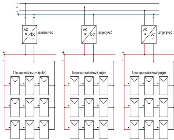
Slika 4. 9. FN sustav u izvedbi s više izmjenjivača[26]
