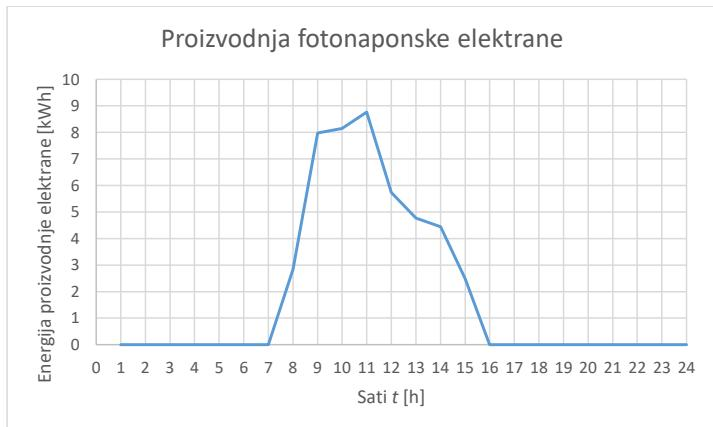
Slika 6. 2. Proizvodnje fotonaponske elektrane zgrade za zimski dan (20.01.2020)
