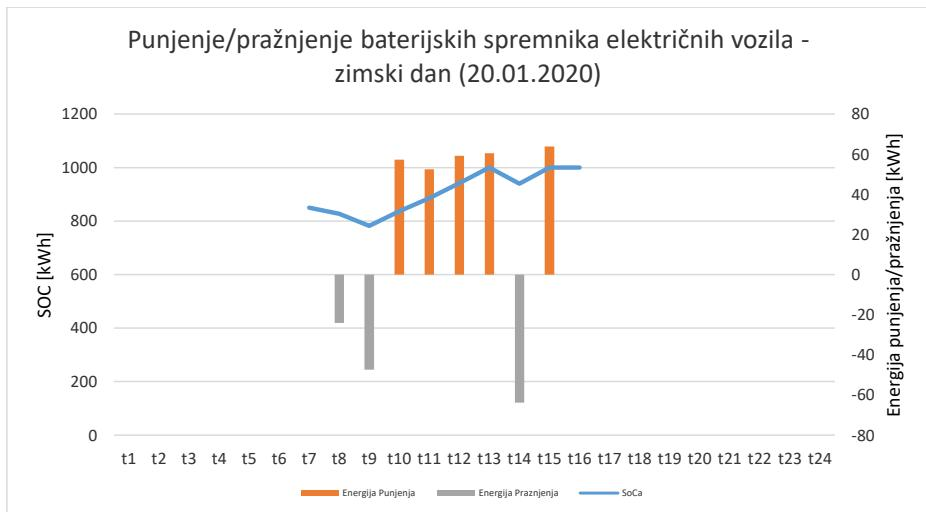
Slika 6. 9. Optimalno punjenje/praznjenje baterijskih spremnika električnih vozila na zimski dan
