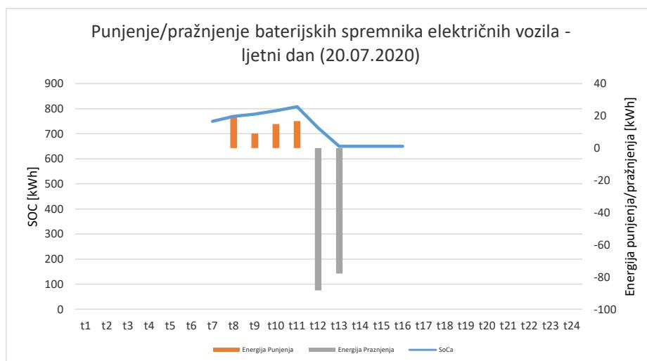
Slika 6. 12.Optimalno punjenje i praznjenje baterijskih spremnika električnih vozila na ljetni dan
