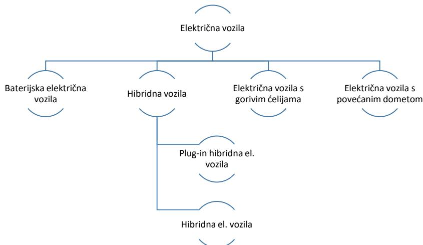
Slika 3. 1. Klasifikacija električnih vozila
