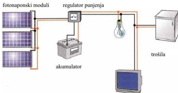
Slika 4. 3. Off-grid FN sustav za istosmjerna trošila[25]
