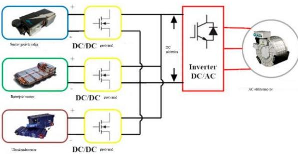
Slika 3. 16. Konfiguracija hibridnog električnog vozila s gorivim ćelijama[22]
