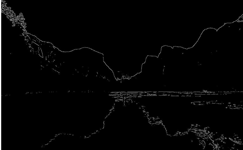
Slika 4.7. Fotografija jezera nakon primjene Canny Edge Detection algoritma s parametrima 255,255
