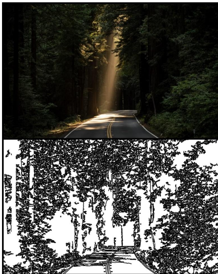
Slika 4.14. Fotografija ceste [18] prije i poslije primjene algoritma Canny Edge Detection
