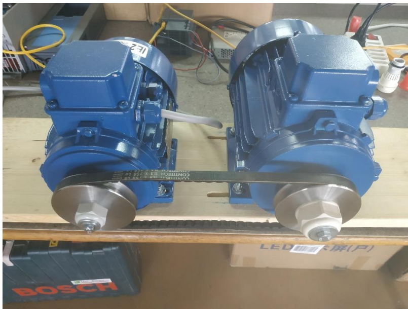
Slika 2.1 – Prikaz dva asinkronog motora (0.75kW i 2.2kW).
