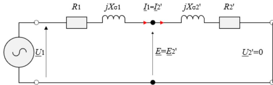
Sl. 3.4. Nadomjesna shema transformatora pri kratkom spoju
