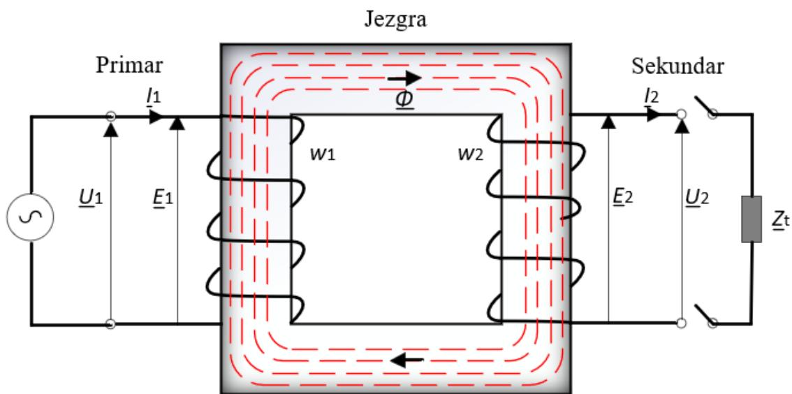
Sl. 3.2. Pojednostavljeni prikaz transformatora
