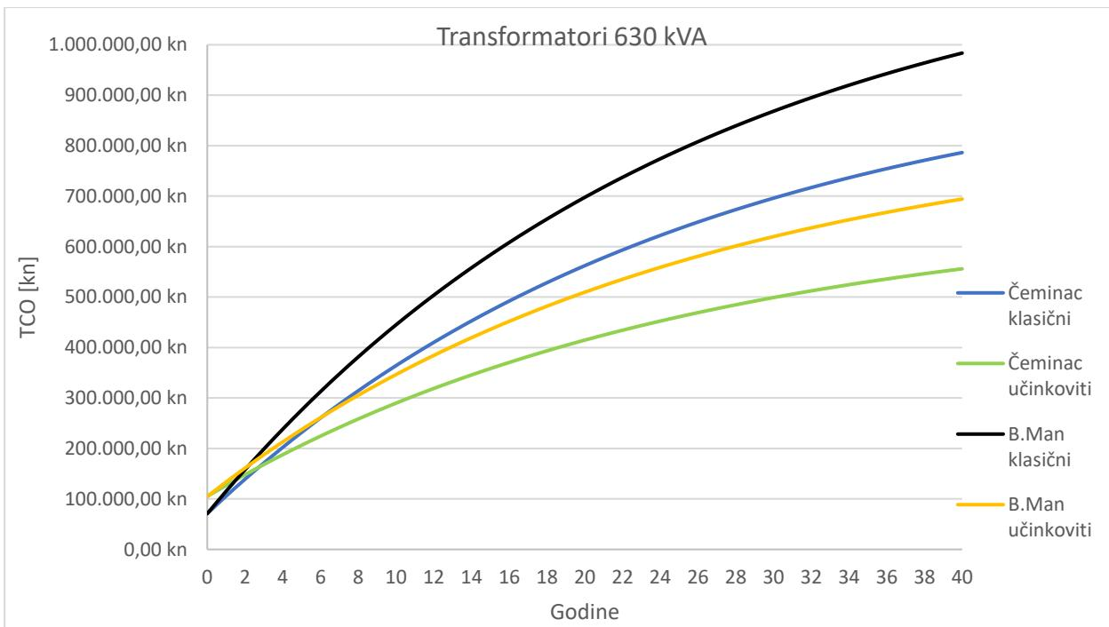
**Sl. 6.1.** Usporedba isplativosti zamjene transformatora 630 kVA
