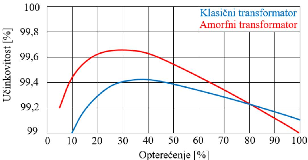
Sl. 4.4. Usporedba učinkovitosti u ovisnosti o opterećenju klasičnog i amorfjnog transformatora
