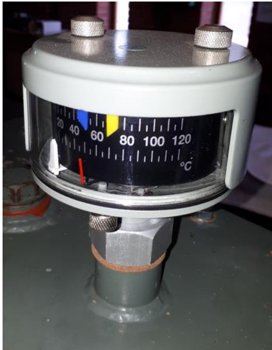
Sl. 3.16. Bimetalni termometar za vertikalnu ugradnju
