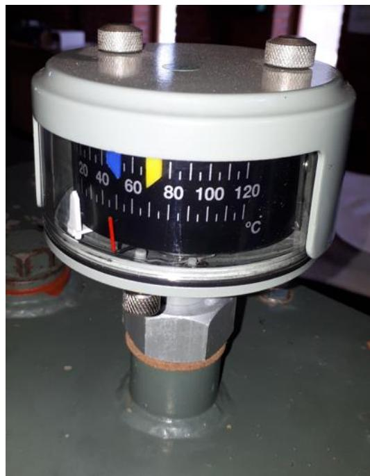
**Sl. 3.16.** Bimetalični termometar za vertikalnu ugradnju
