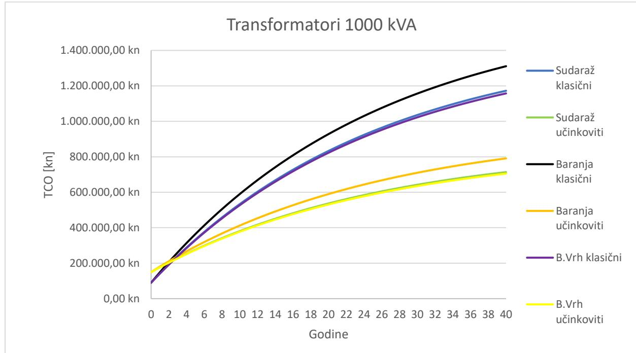
**Sl. 6.5.** Usporedba isplativosti zamjene transformatora 1000 kVA
