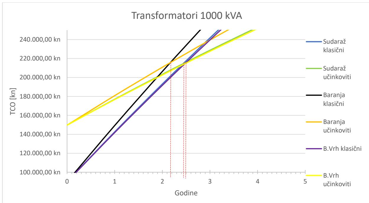
**Sl. 6.6.** Uvećani prikaz usporedbe isplativosti zamjene transformatora 1000 kVA
