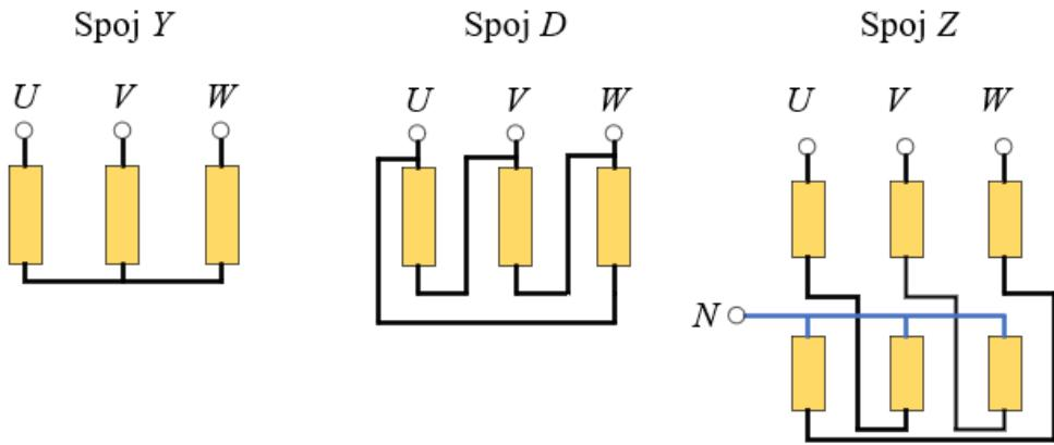
**Sl. 3.9.** Sheme spojeva namota transformatora
