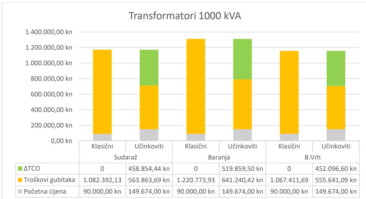
**Sl. 6.7.** Usporedba komponenata  $TCO$  metode za 1000 kVA transformatore
