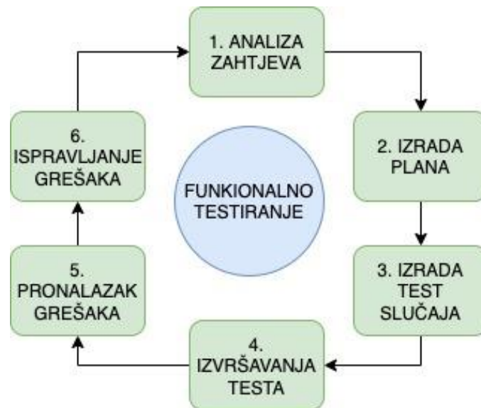
Slika 2.3. Proces funkcionalnog testiranja
