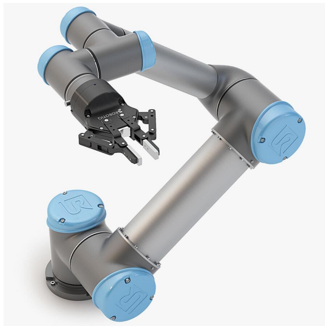
Slika 4.2. UR5 robot s Robotiq hvataljkom s dva prsta
