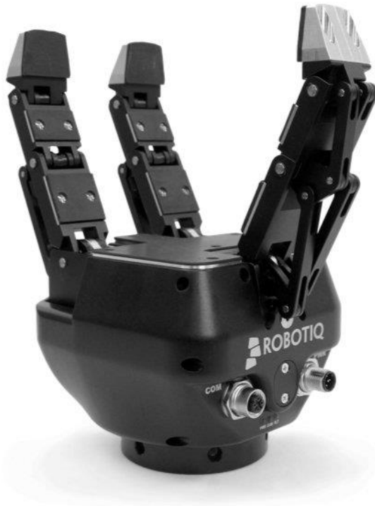
Slika 4.4. Prikaz Robotiq hvataljke s 3 prsta
