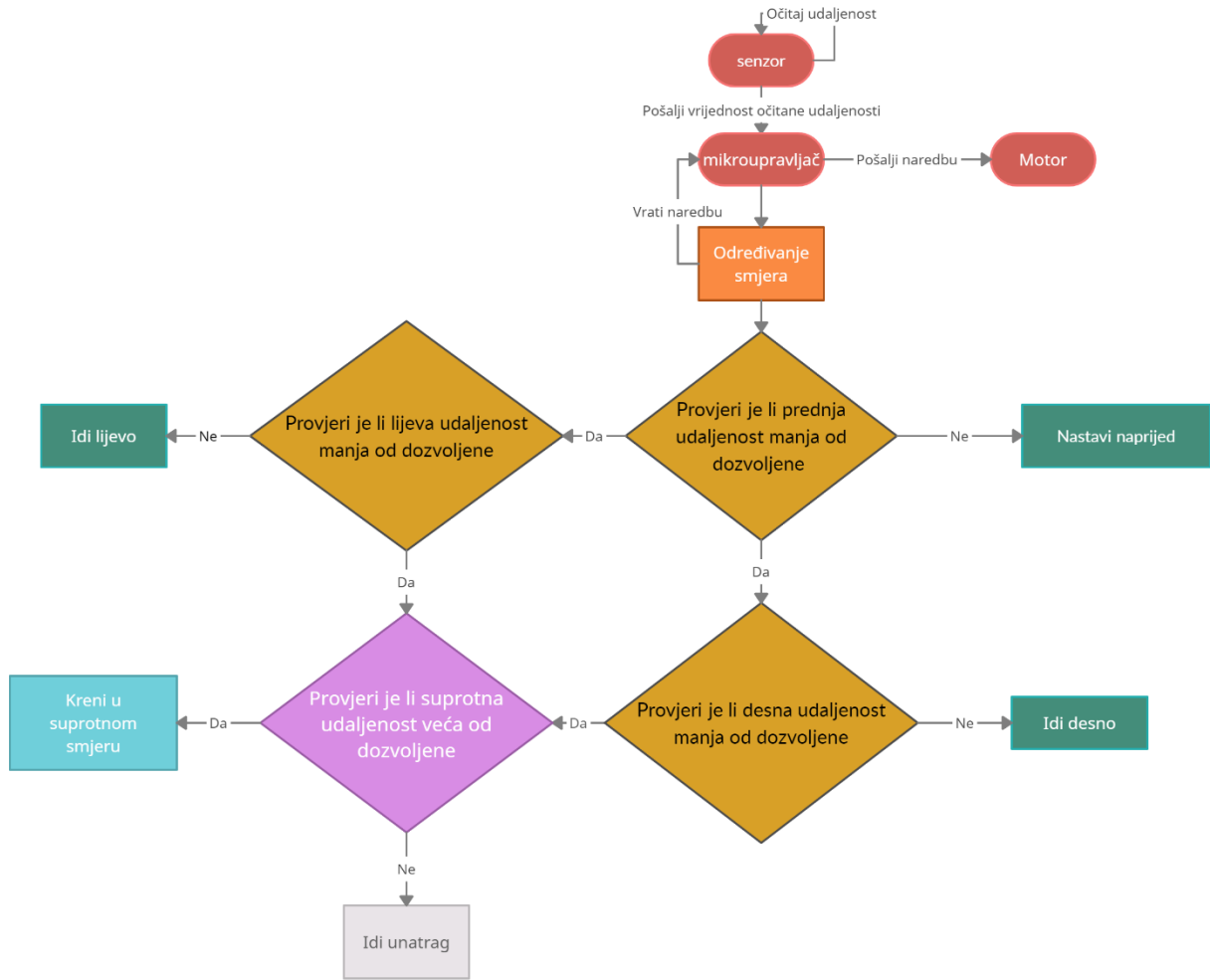
Slika 3.3. Projektirana sklopovska i programska arhitektura modela autonomnog vozila.
