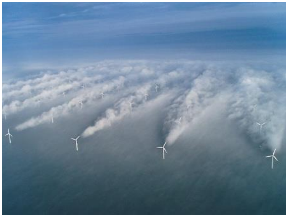
Sl. 4.12. Efekt međusobnog zaklanjanja (zavjetrine) [21]
