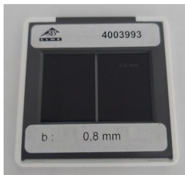
Slika 6.18. Prikaz korištene pukotine širine 0,8 mm
