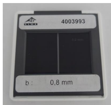
Slika 6.18. Prikaz korištene pukotine širine 0,8 mm
