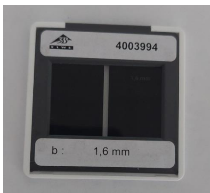
Slika 6.21. Prikaz korištene pukotine širine 1,6 mm
