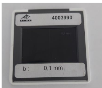
Slika 6.9. Prikaz korištene pukotine širine 0,1 mm
