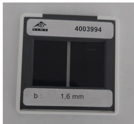
Slika 6.21. Prikaz korištene pukotine širine 1,6 mm
