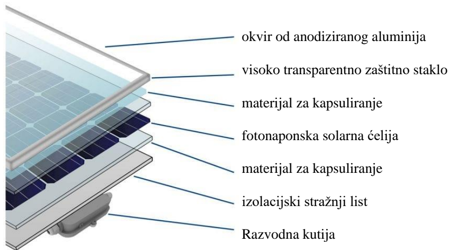
Slika 3.11, Prikaz sastava fotonaponske ćelije [24]
