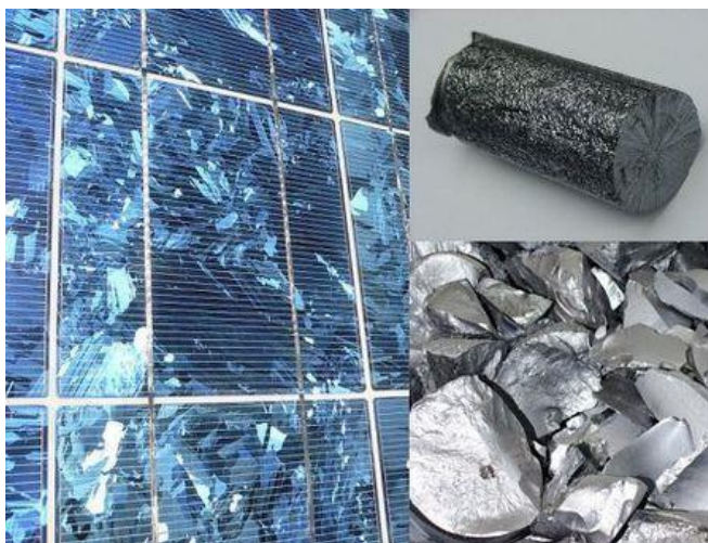
Slika 3.3, Oblici polikristalnog silicija [13]
