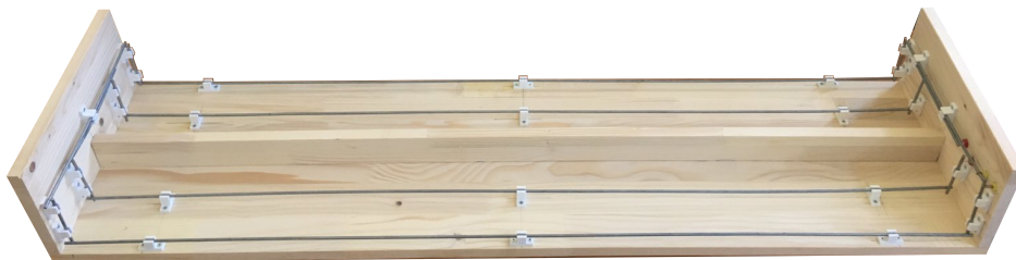
Slika 4.18: Prototip zavojnice (pogled odozdo)
