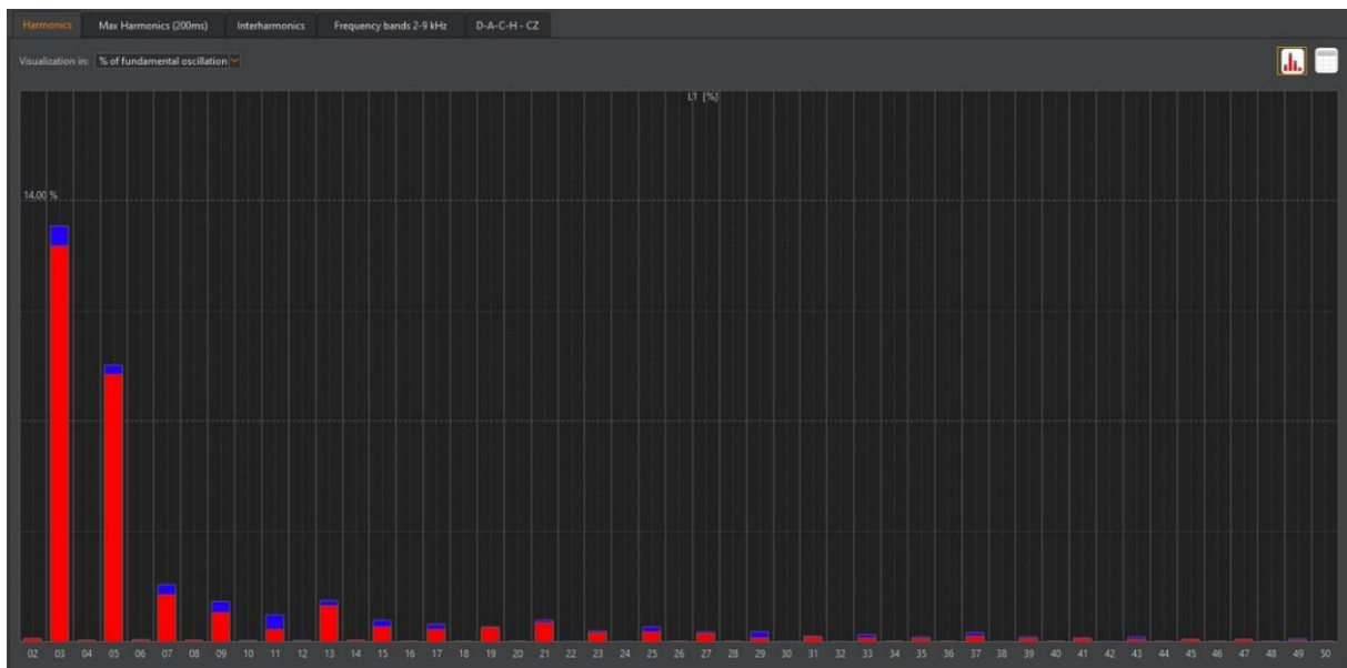
Slika 6.24. Harmonijski spektar struje - relativne vrijednosti u drugom tjednu mjerenja
