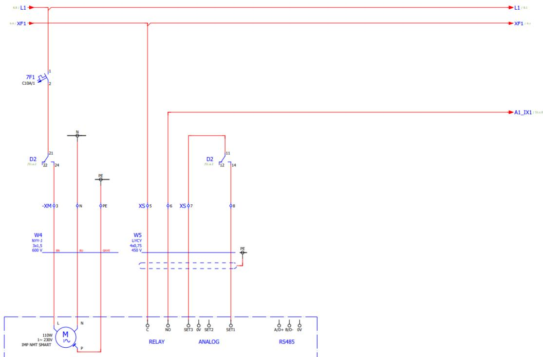
**Slika 4.11** Cirko pumpa - ventilokonvektori 1.kat uredski dio - grijanje/hlađenje [6]
