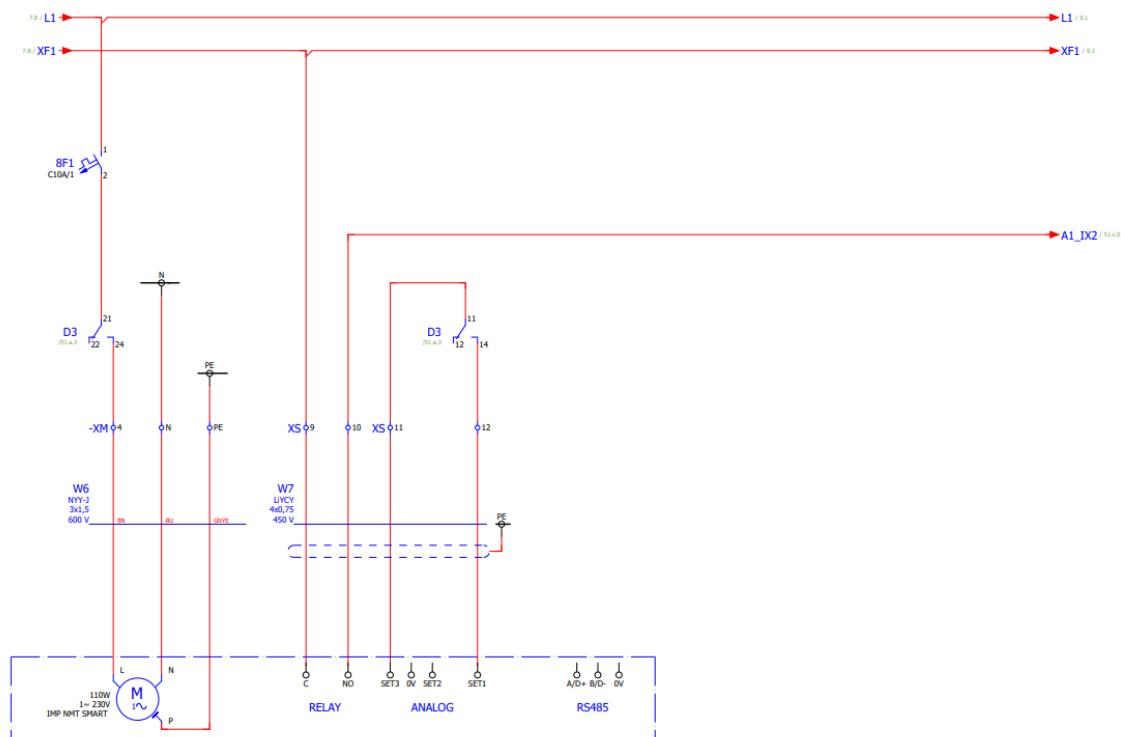
**Slika 4.12** Cirko pumpa ventilokonvektori 1.kat u pogonu - grijanje/hlađenje [6]
