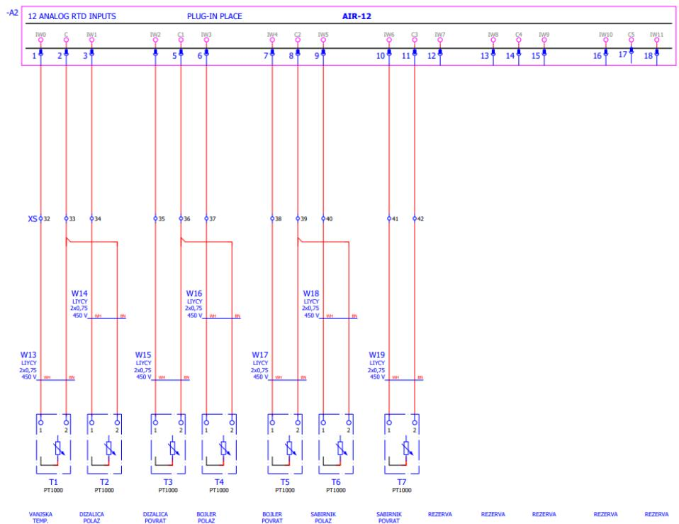
**Slika 4.20** Shema spajanja PT1000 sondi - 12 analogni RTD inputi [6]
