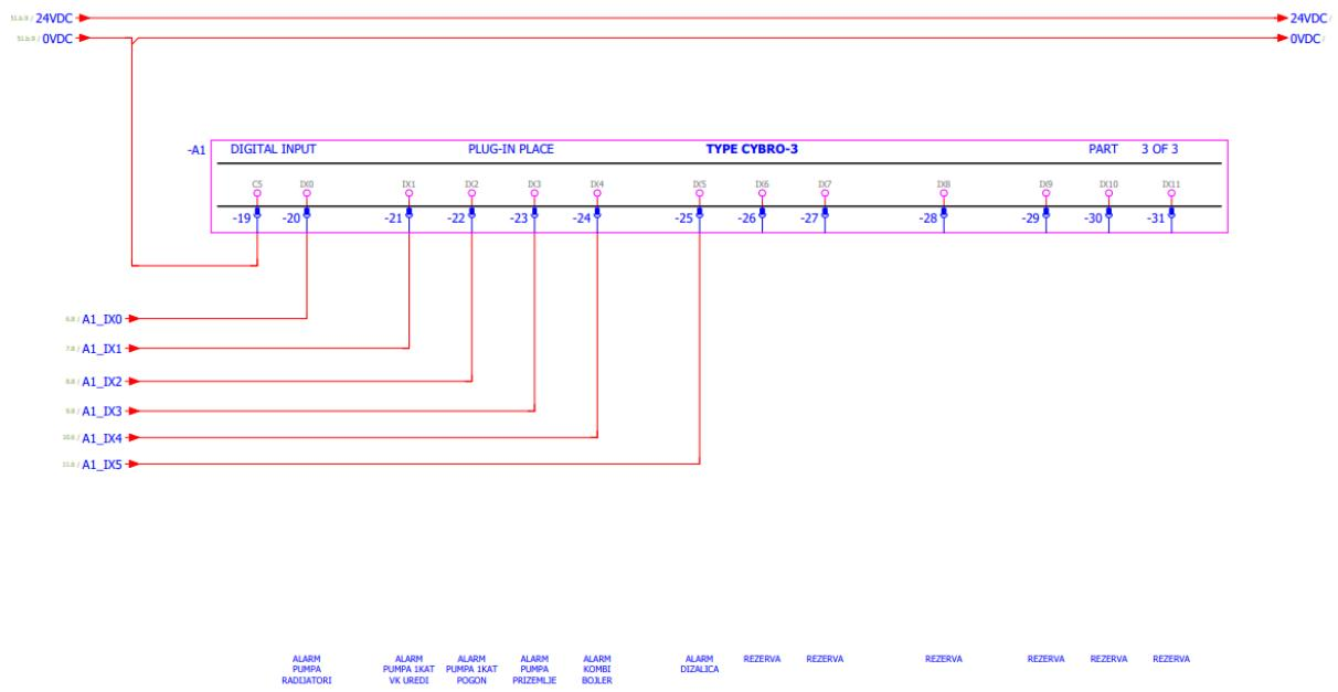
**Slika 4.19** Digitalni input – 12 DI [6]
