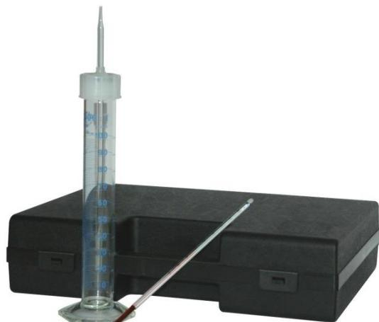
*Slika 3.11 Mjerenje se izvodi sa cilindrom i klipom(napunjen određenim uzorkom vina) koji se nalazi u cilindru, cilindar se promućka te se iz njega izbacuje volumen uzorka koji je proporcionalan volumenu rastvorenog CO<sub>2</sub>, volumen vina, koji je ostao uz pomoć korekcijskih tablica za temperaturu uzorka, određuje sadržaj CO<sub>2</sub> [30] [31]*
