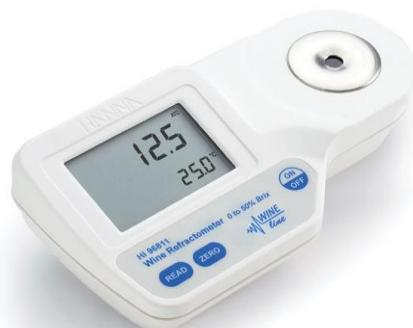
*Slika 3.7 Vinski refraktometar marke HANNA oznake HI-96811, mjeri indeks loma svjetlosti i prikazuje udio šećera na temelju uzorka. Također postoji refraktometar iste marke istog izgleda ovome, ali oznake HI-96812 koji pokazuje rezultate Baume ljestvice (također služi za mjerjenje šećera te ovisi o gustoći tekućine) [14] [16]*
