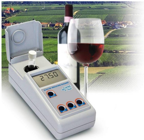
Slika 3.6 Fotometar koji mjeri koncentraciju reducirajućih šećera, njihova količina vrlo bitna u komercijalnoj proizvodnji vina, potrebno ih mjeriti kako bi se dobila željena slatkoća i koncentracija alkohola [14] [15]
