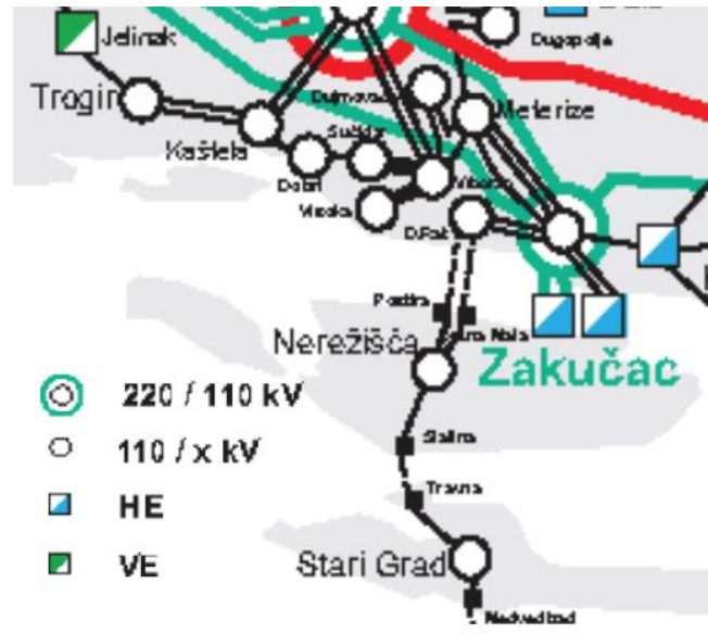
Slika 4.15. Elektroenergetska mreža na potezu Omiš-Makarska[41]
