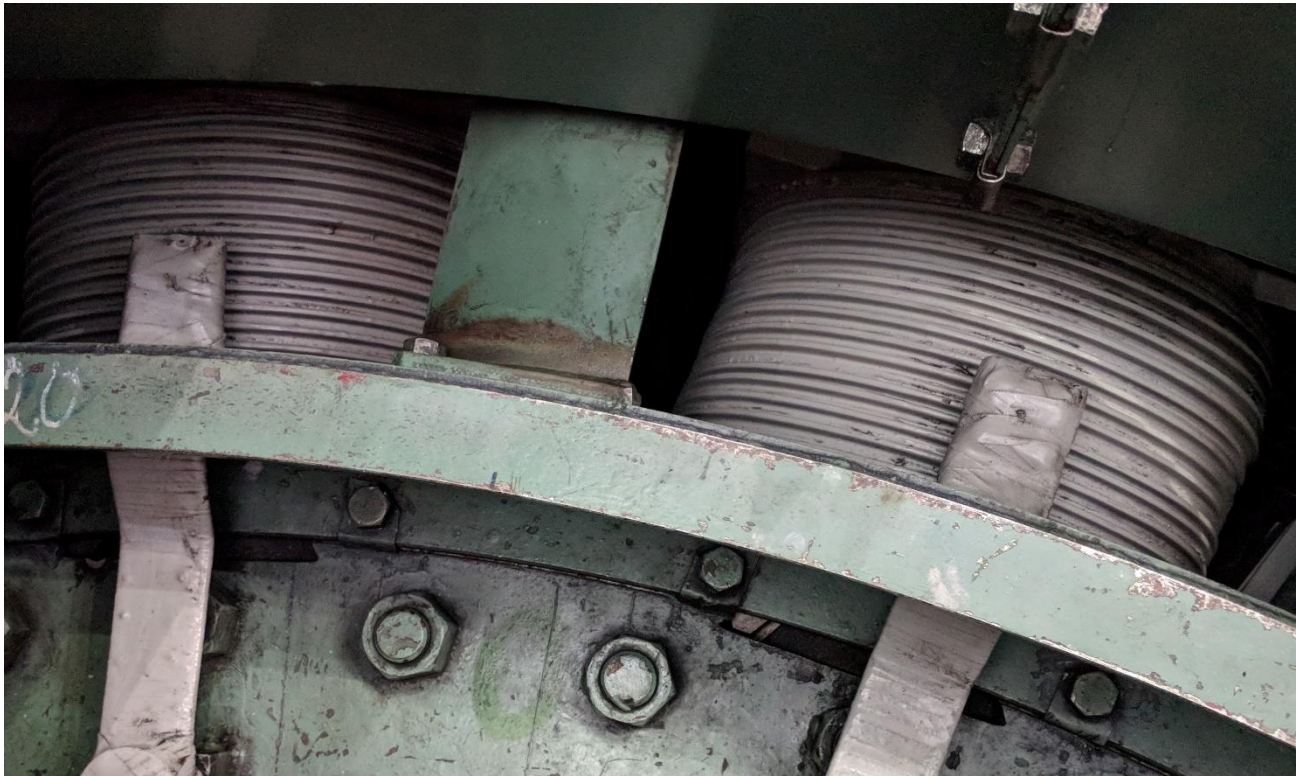
Slika 5.1. Prikaz zavoja u namotu rotora
