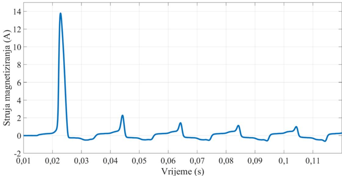
**Slika 2.2.** Udarna struja magnetiziranja [1]
