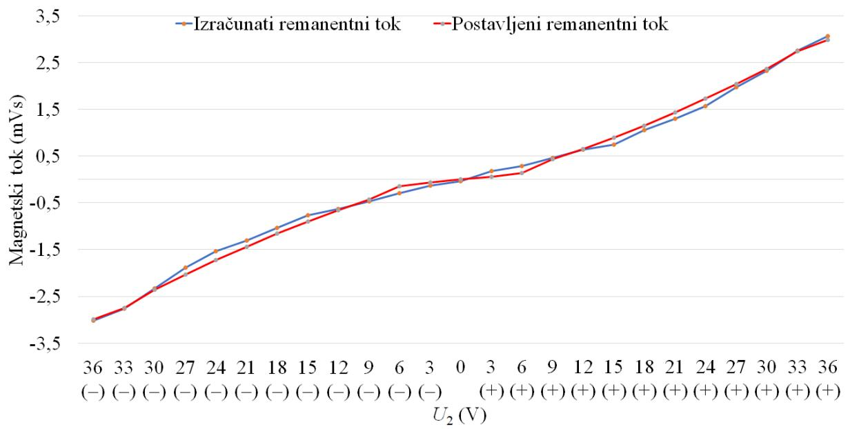
**Slika 4.11.** Usporedba izračunatog i postavljenog remanentnog toka [1]
