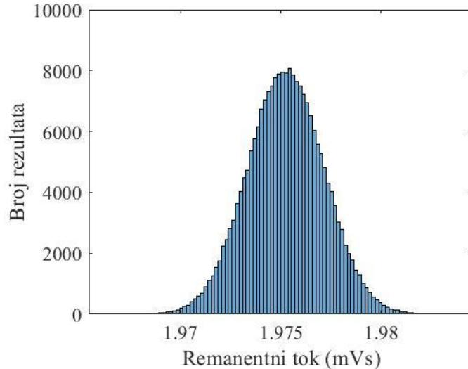
**Slika 5.2.** Razdioba zaostalog toka za postavljenu relativnu nesigurnost napona sekundara od 2 % pri naponu  $U_2 = 27$  V (+).
