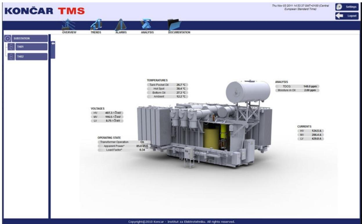
Slika 2.6. Končar TMS, sustav nadzora rada transformatora [19]
