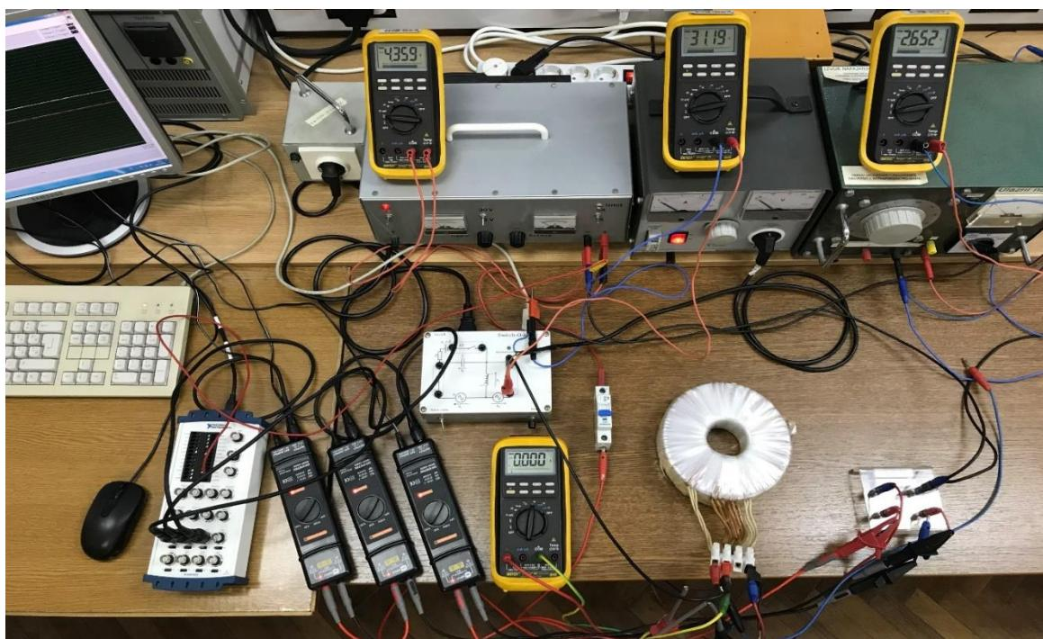
**Slika 4.2.** Laboratorijski postav za određivanje remanentnog toka [1]
