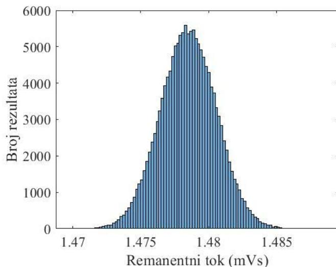
**Slika 5.1.** Razdioba zaostalog toka za postavljenu relativnu nesigurnost napona sekundara od 2 % pri naponu  $U_2 = 21 \text{ V} (+)$ .
