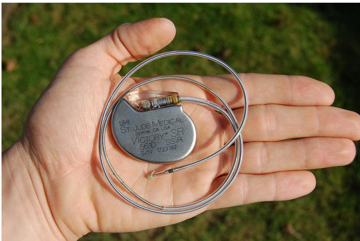
Slika 3.4. Usporedba veličine pacemakera sa ljudskom šakom, pri čemu baterija pacemakera ne zauzima niti polovinu ukupne veličine samog uređaja [10]
