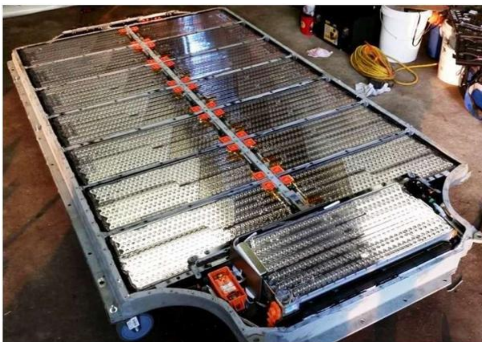
Slika 6.1. Paket baterija Tesla Model S [38]
