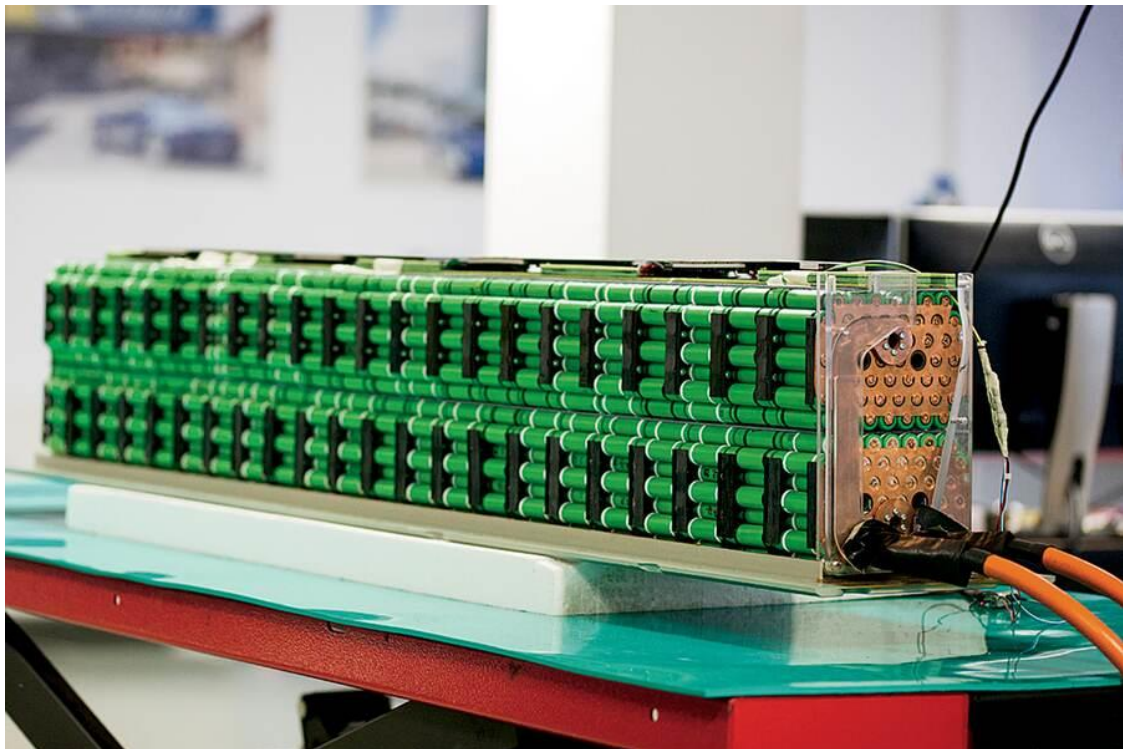
Slika 3.1. Primjer povezivanja baterija Rimac automobila [6]
