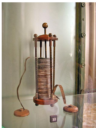
Slika 2.2. Električna baterija Alessandra Volte [4]
